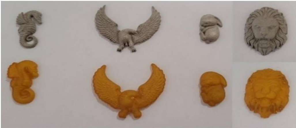
Şekil 4.19 3B kalıplardan üretilmiş saf gümüş metal kil hamurları
