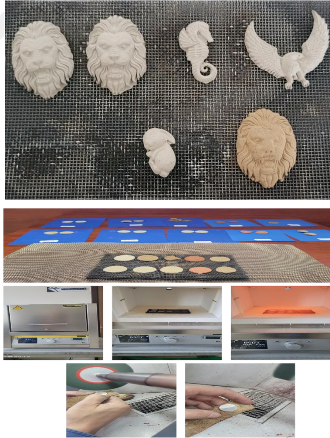
Şekil 3.1 Metal kil hamurlarının sinterleme ve sonraki işlem görüntüleri
