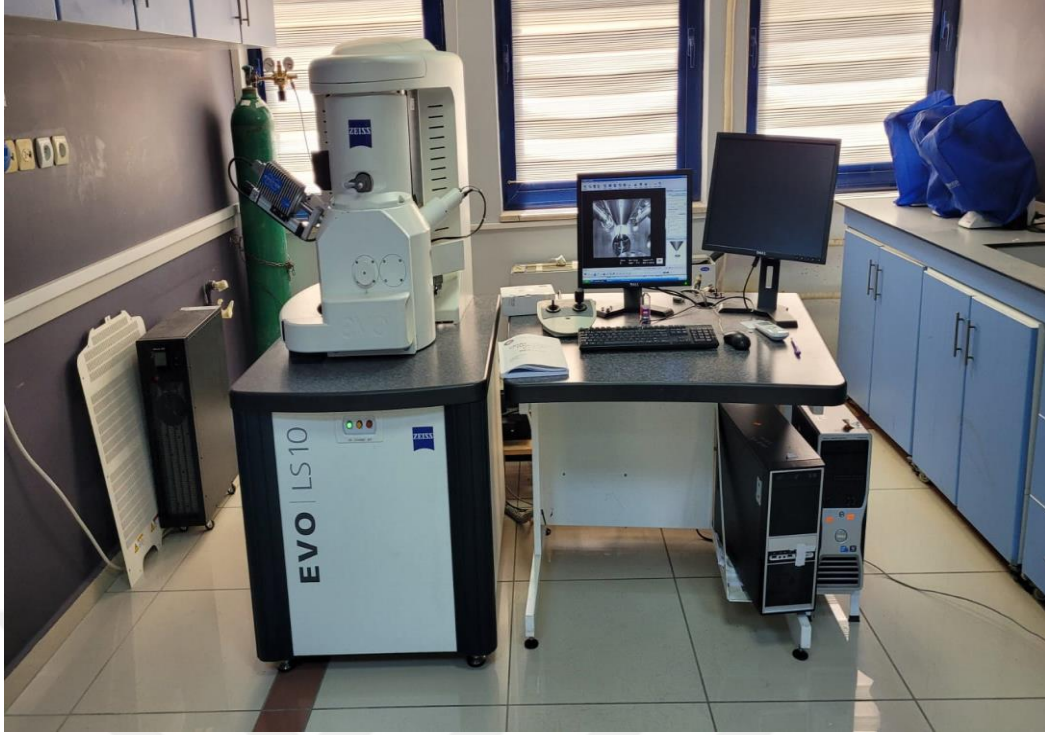
Şekil 3.3 Taramalı elektron mikroskobu Zeiss Evo LS10 (SEM) cihazı
