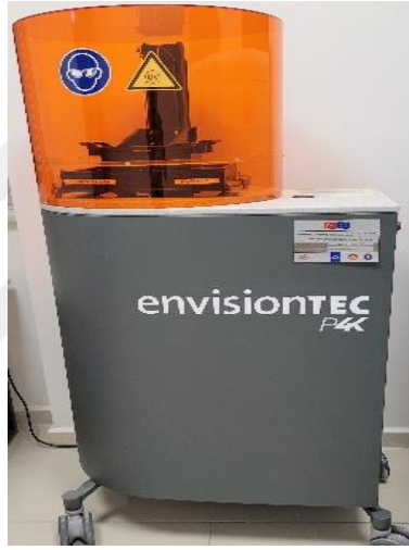
Şekil 4.18 3B kalıp üretimi için kullanılan Envisiontec P4k reçine makinesi
