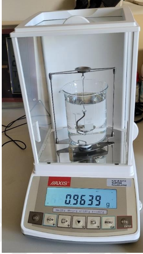
Şekil 3.6 Yoğunluk testinde kullanılan terazi
