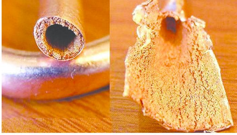
Şekil 1.11 Isı borusunun iç cidarlarındaki gözenekli yapı
