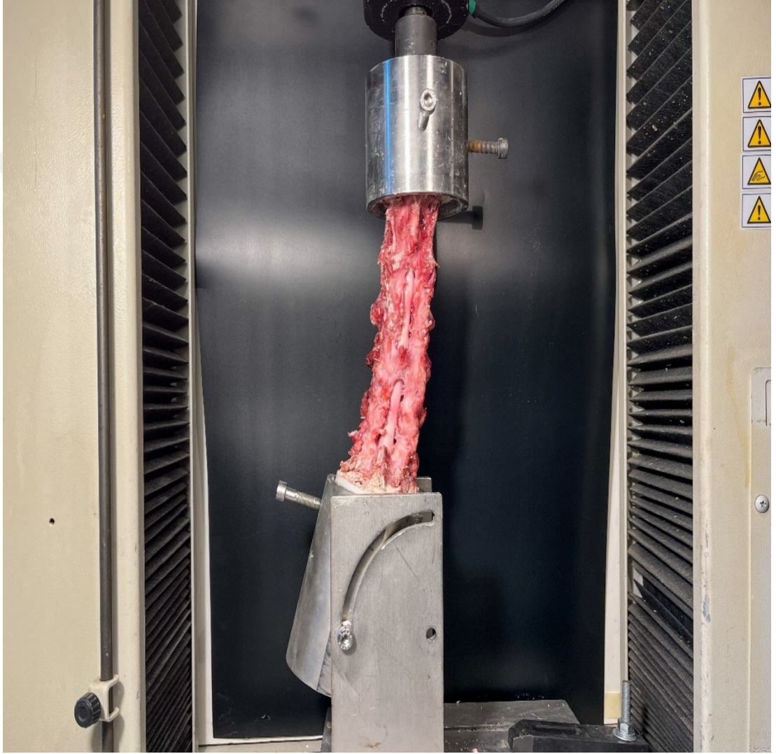
Resim-7: Atlayarak laminektomi grubu piyesin sol yana eğilme testi
