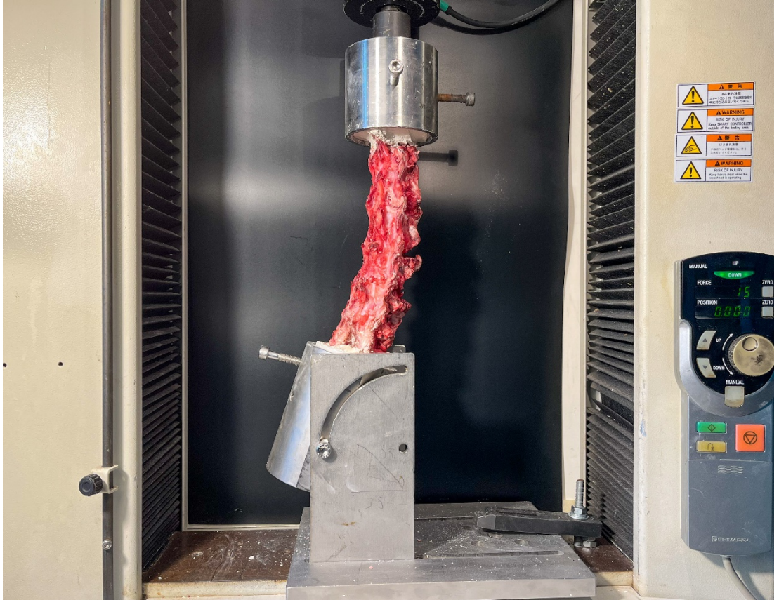
Resim-5: Kontrol grubu piyesin fleksiyon testi
