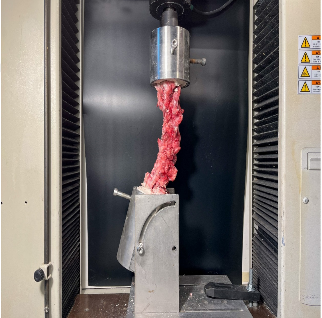
Resim-6: Atlayarak laminektomi grubu piyesin ekstansiyon testi
