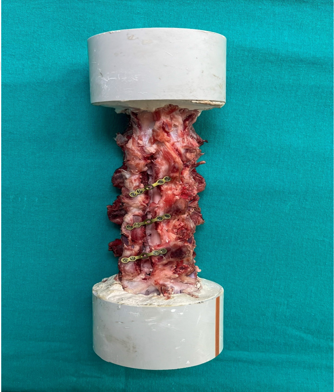
Resim-2: Laminoplasti operasyonu uygulanmış piyes örneği
