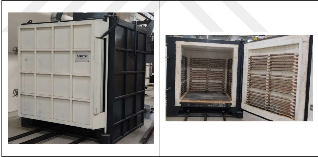
Şekil 3.3. Yangına maruz bırakılan numuneler için kullanılan yangın fırını
