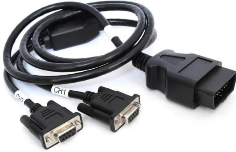
Şekil 3.4. SAE J1962 bağlantı konektörlerinin 16 pinli modelinin gerçek görüntüsü [39]
