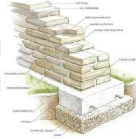
Şekil 2.27 Harçlı taş duvar uygulama şekli ve uygulama örneği (Sagui, 2009)
