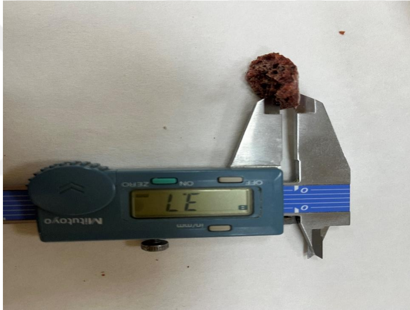
Şekil 2.5. Kumpas Cihazı ile Ekmek Kabuk Kalınlığı Ölçümü
