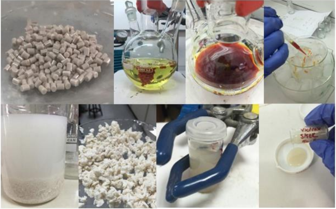
Şekil 3.10: PEEK polimerinin sülfonasyonu ile SPEEK hazırlanması süreçlerine ait görüntüler.
