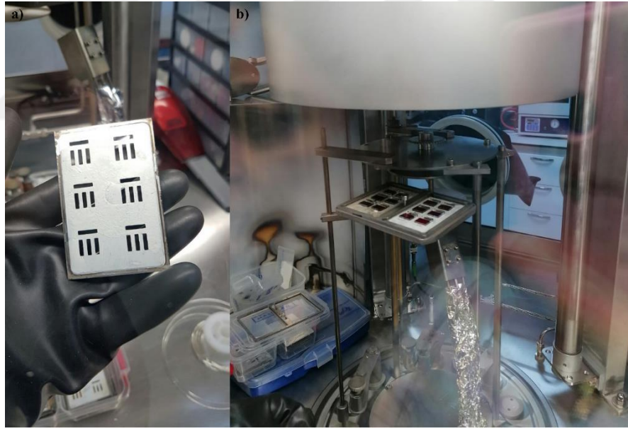
Şekil 3.9. a) Kullanılan 3 katotlu maske yapısı b) PVD kaplama için yerleştirilen 12 adet pil
