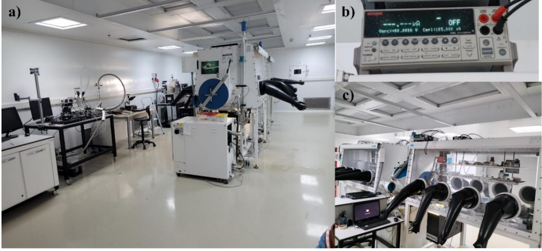
Şekil 3.11. Temiz oda laboratuvarı b) Keithley 2400 potansiyostat c) Glovebox sistemi
