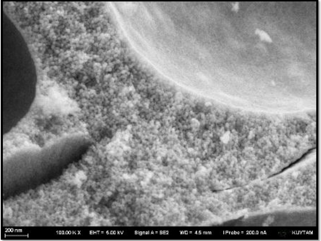
Şekil 4.33: Sol-jel tekniğiyle üretilen ve 800°C'de ısıtılmış \text{Co}(\text{Ga}_{0.25},\text{Al}_{0.75})_2\text{O}_4 %25 Ga, %75Al katkılı toz örneğinin SEM görüntüsü.
