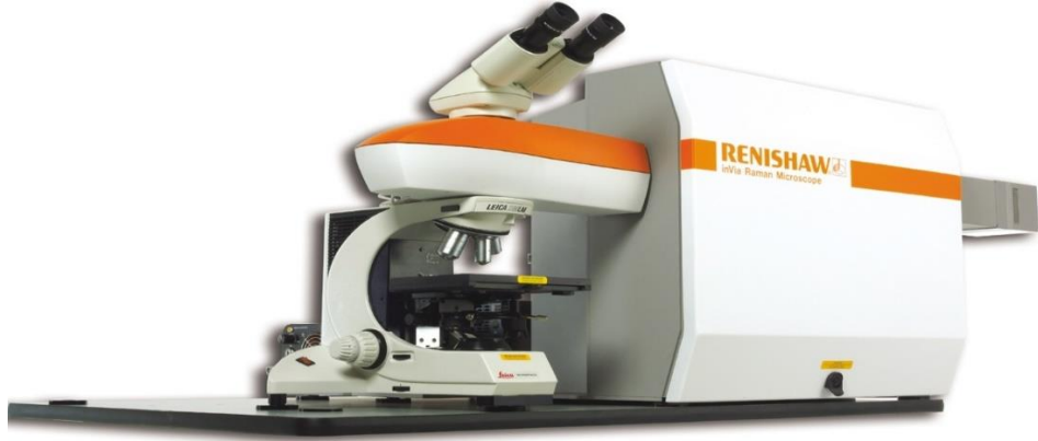
Şekil 3.6. Renishaw inVia konfokal Raman mikroskobu
