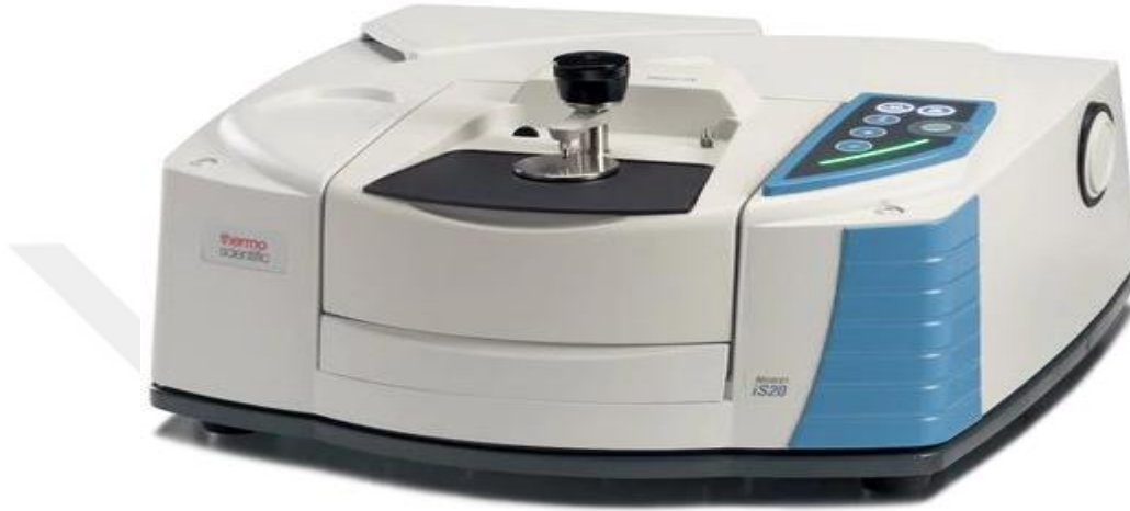
Şekil 3.5. Thermo Scientific -Nicolet iS20 FTIR cihazı
