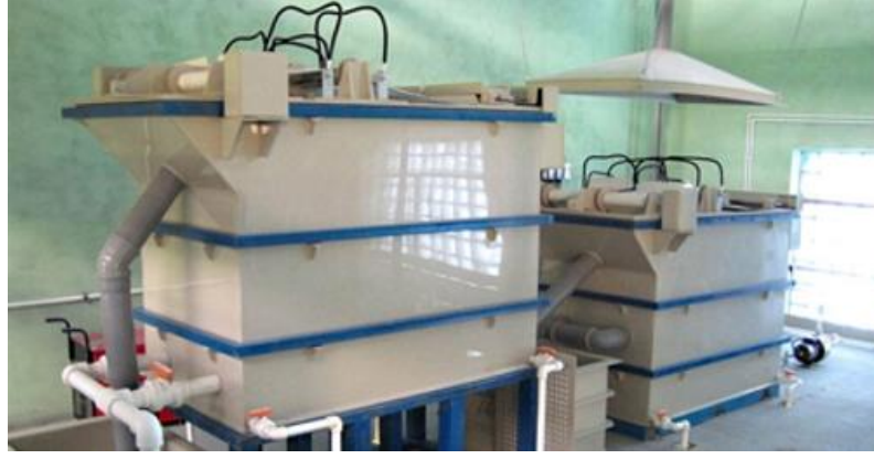
Şekil 3.8. Elektroflotasyon prototip sistemin düzeneği.
