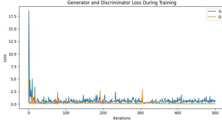
Şekil 4.10 LSGAN modelinin 500 epoch sonrası üretici ve ayırt edici kayıp grafiği
