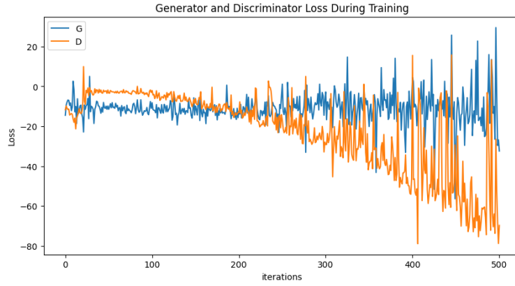
Şekil 4.12 WGAN modelinin 500 epoch sonrası üretici ve ayırt edici kayıp grafiği
