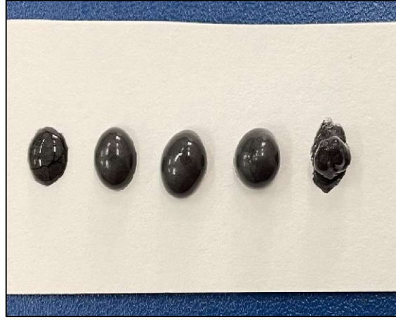
Şekil 5.12 XG bağlayıcı oranları ile hazırlanmış iletken mürekkeplerin karton altlığı damlatılmasıyla oluşan görünümleri
