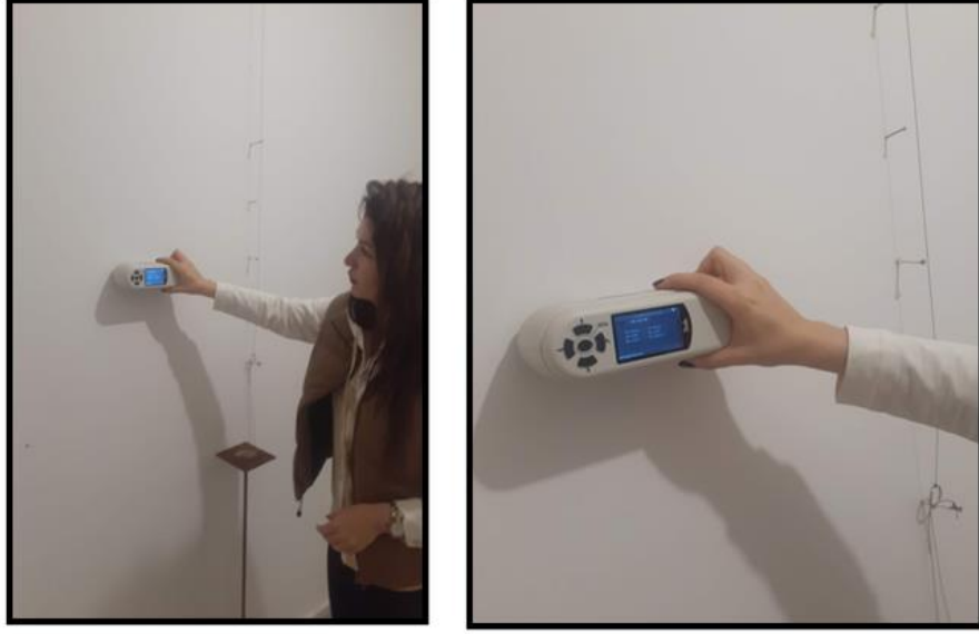
Şekil 3.4. Deney ortamından CIELAB cihazı ile ölçüm gösterimi-1
