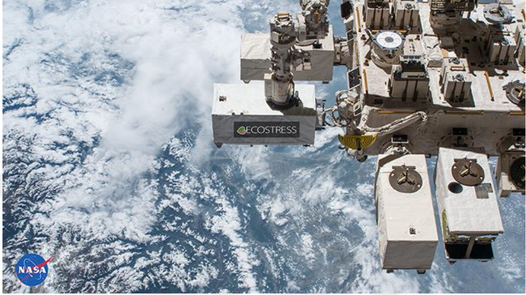
Şekil 1.3. ECOSTRESS radyometresi Uluslararası Uzay İstasyonu'nda (Uİİ) Japon Deney Modülü (url-2)
