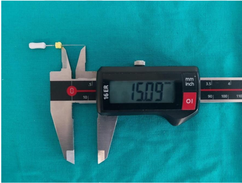
Şekil 2.6. Stoperin alt kısmı ile eğre ucu arası mesafenin \pm 0.01 mm hassasiyet gösteren dijital kumpas yardımıyla ölçülmesi
