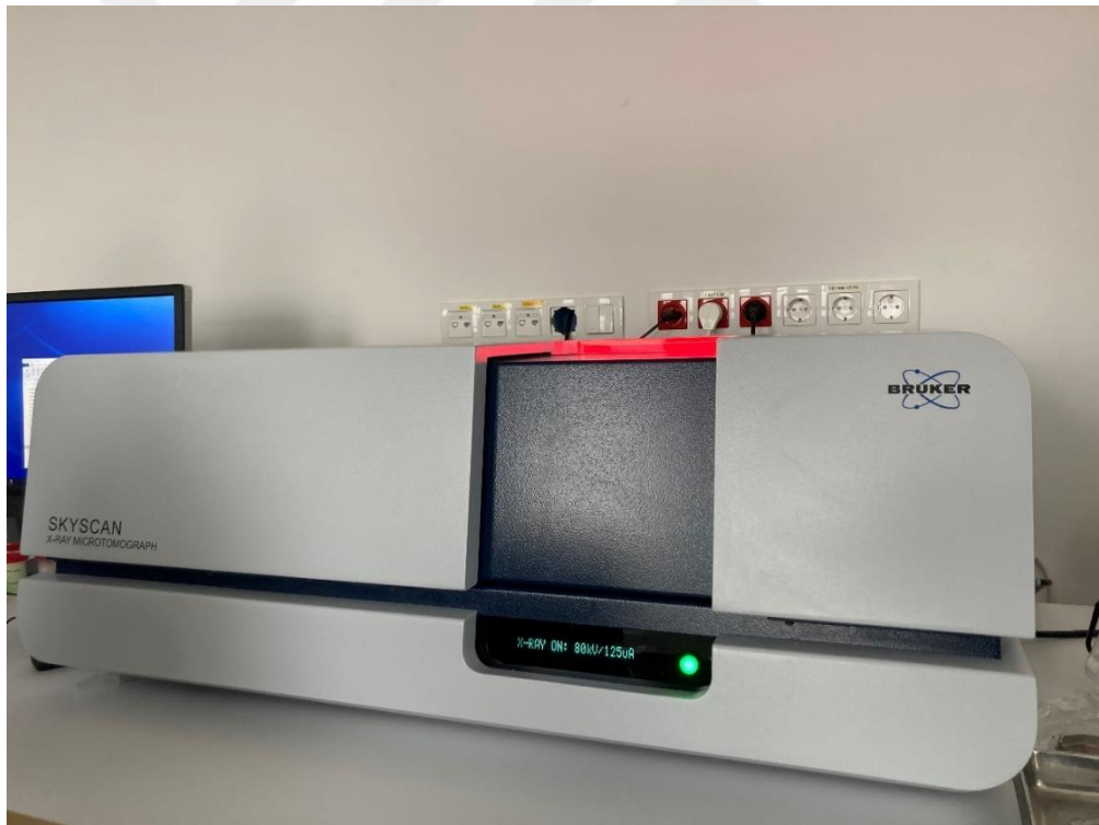
Şekil 3.2. Mikro-BT cihazı (Bruker SkyScan 1275 X-Ray Mikrotomografi, Antwerp, Belçika).
