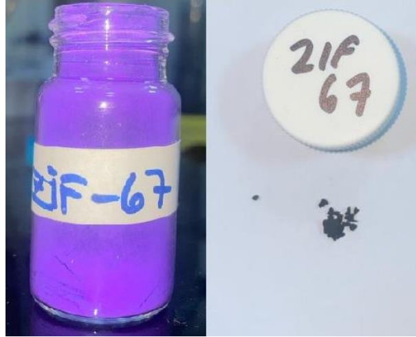
Şekil 2. Sentezlenen toz formunda ZIF-67 (sol), piroliz işlemi sonrasında P-N-ZIF-67 (sağ)
