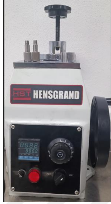
Şekil 7.3. Sıcak Bakalit Cihazı
