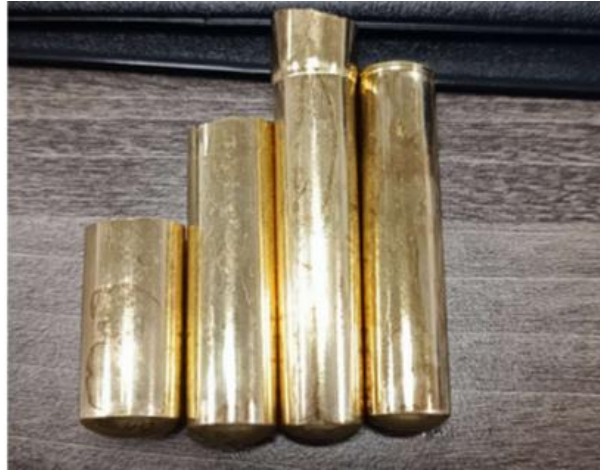
Şekil 8.14. 670°C Sıcaklıkta 1 Saat Tavlanan CuZn30 Kovan Yüksük Derin Çekme İşlemi
