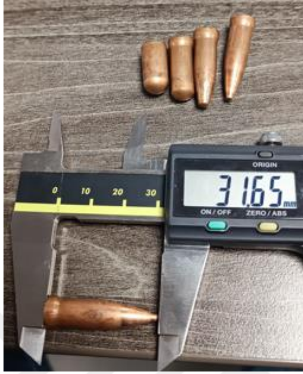
Şekil 8.6. 600 °C'de Tavllanmış CuZn10 Mermi Yüksük Numunesi Derin Çekme Sonrası Boy Uzaması
