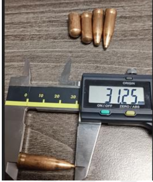
Şekil 8.4. 400 °C'de Tavllanmış CuZn10 Mermi Yüksük Numunesi Derin Çekme Sonrası Boy Uzaması
