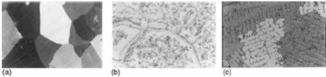
Şekil 5.1. Pirince kalay ilavesinin mikro yapıya etkisi [16].
