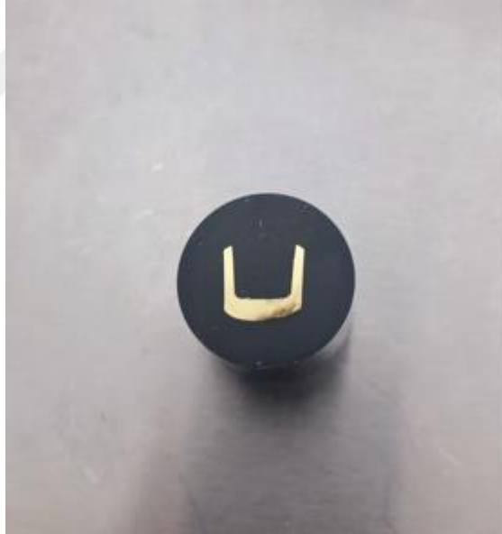
Şekil 7.4. Bakalite Alınan Numune Görseli
