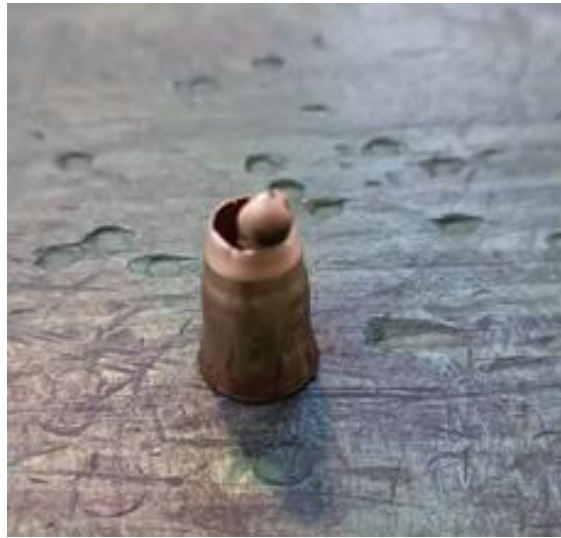
Şekil 8.2. Isıl İşlemsiz CuZn10 Mermi Yüksük Numunesinin Derin Çekme Operasyonundaki Durumu
