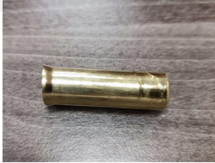
Şekil 8.12. 400 °C Sıcaklıkta 1 Saat Tavlanan CuZn30 Kovan Yüksük Derin Çekme İşlemi
