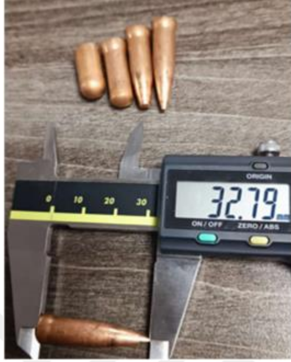
Şekil 8.7. 650 °C CuZn10 Mermi Yüksük Numunesi Derin Çekme Sonrası Boy Uzaması
