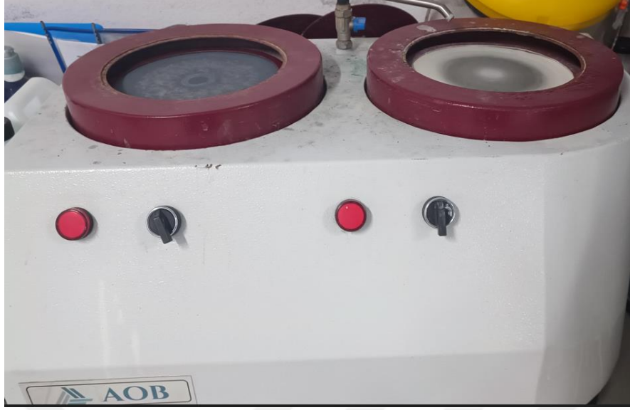
Şekil 7.5. Zımparalama ve Parlatma Cihazı
