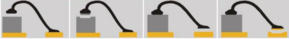
Şekil 2.22 : Telin bilye, kuyruk ve bağlanılan cihazın parçasıyla kopması.
