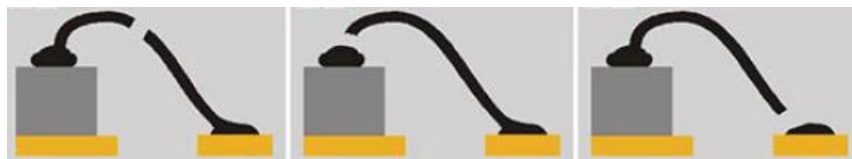
Şekil 2.21 : Telin kanca yerinden, bilye ve kuyruk ekleminde kopması.
