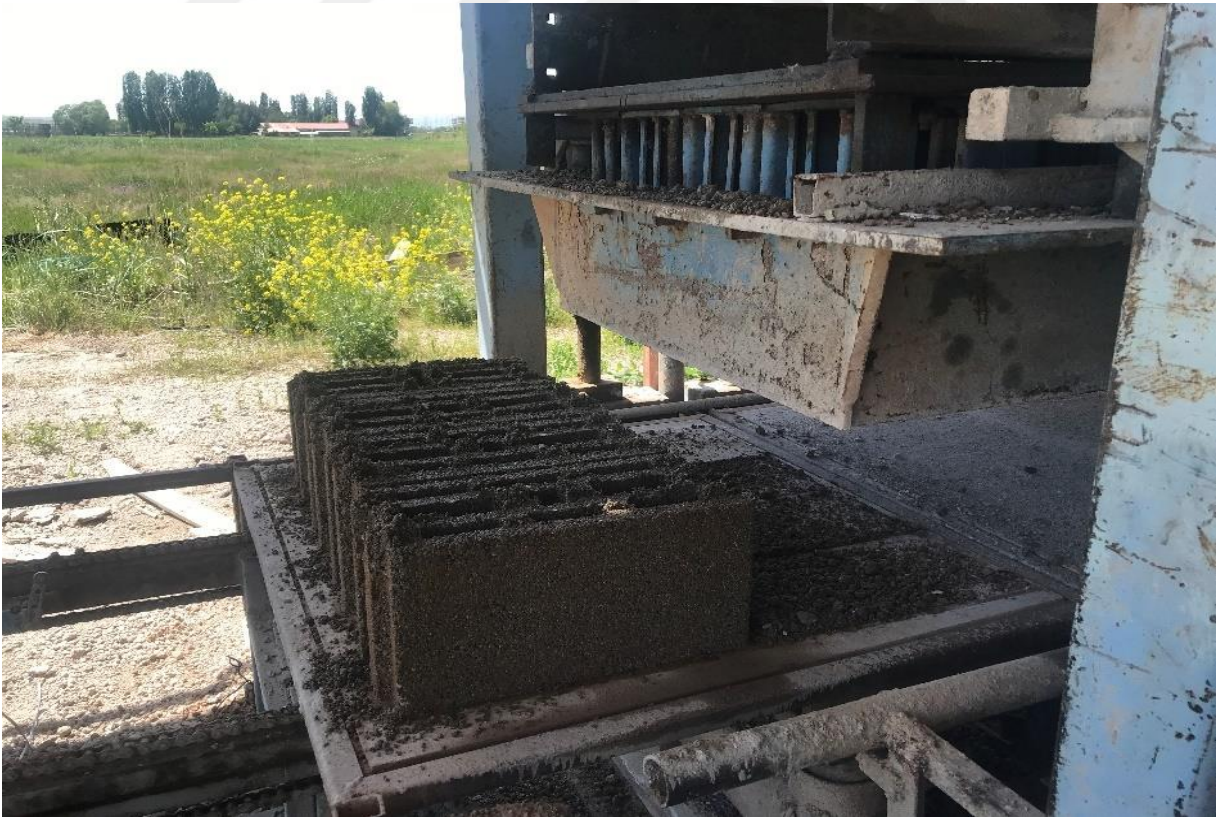
Şekil 11. Bims blok numunelerinin üretimi
