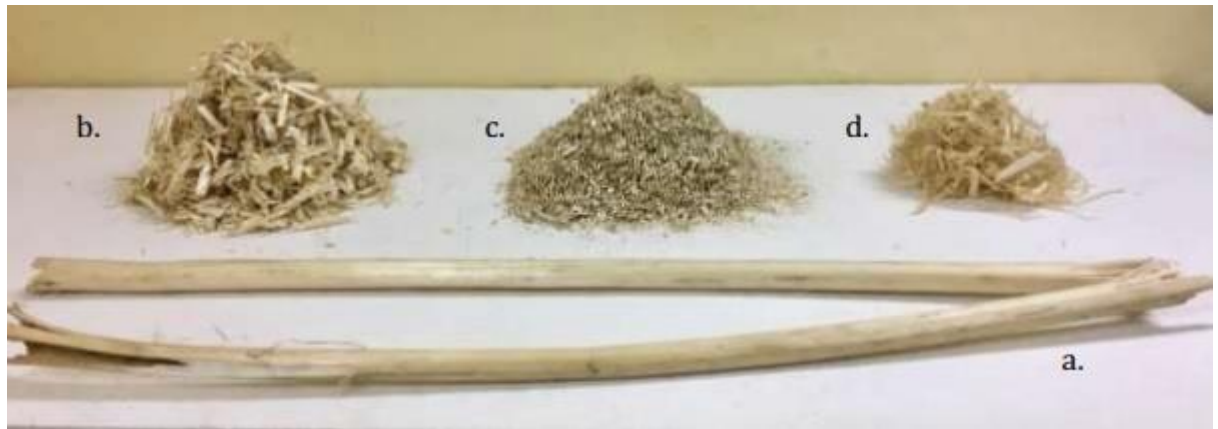
Şekil 4. a. Basit lifleri olmayan, kenevir sapı b. İşlenmiş Kenevir Lifleri c. Yüksek yoğunluklu kenevir betonu yapmak için kenevir parçaları d. Kenevir lifleri (Jami et al. 2018)
