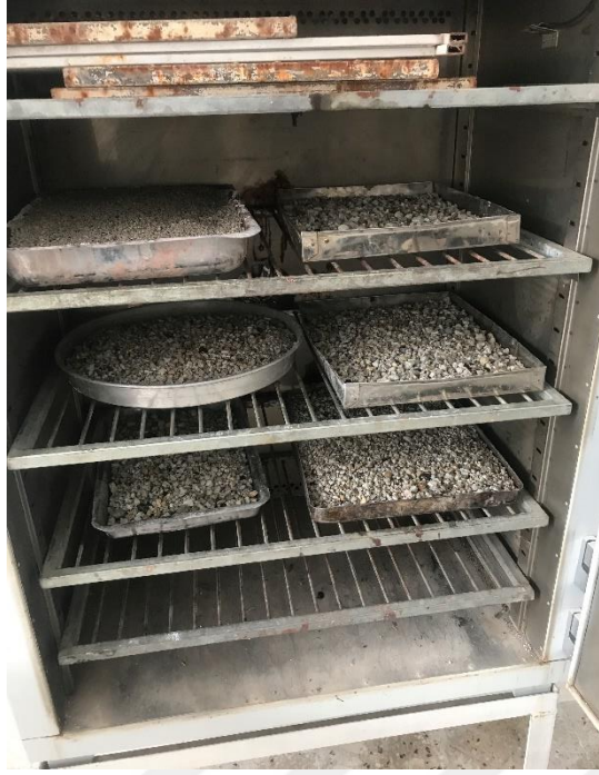
Şekil 9. Pomza agregalarının fırınlama işlemi
