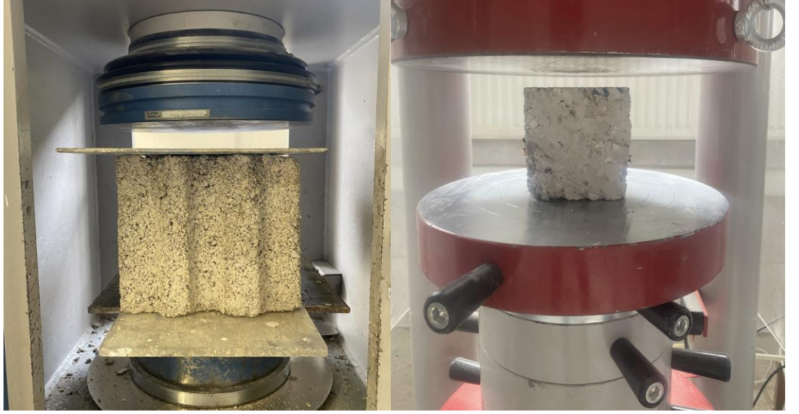
Şekil 21. Basınç deneyi düzeneği
