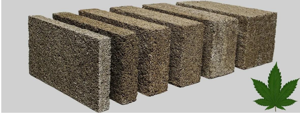
Şekil 5. Kenevir betonu (Anonymous 2023)
