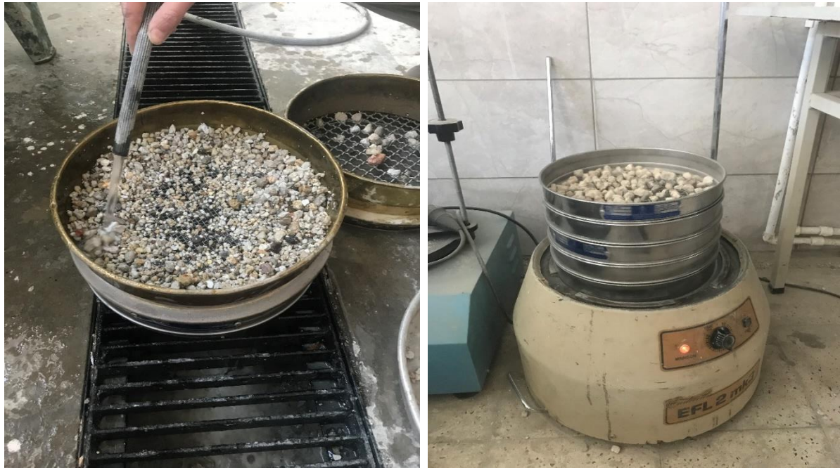
Şekil 8. Pomza agregasının yıkanması ve elek analizi
