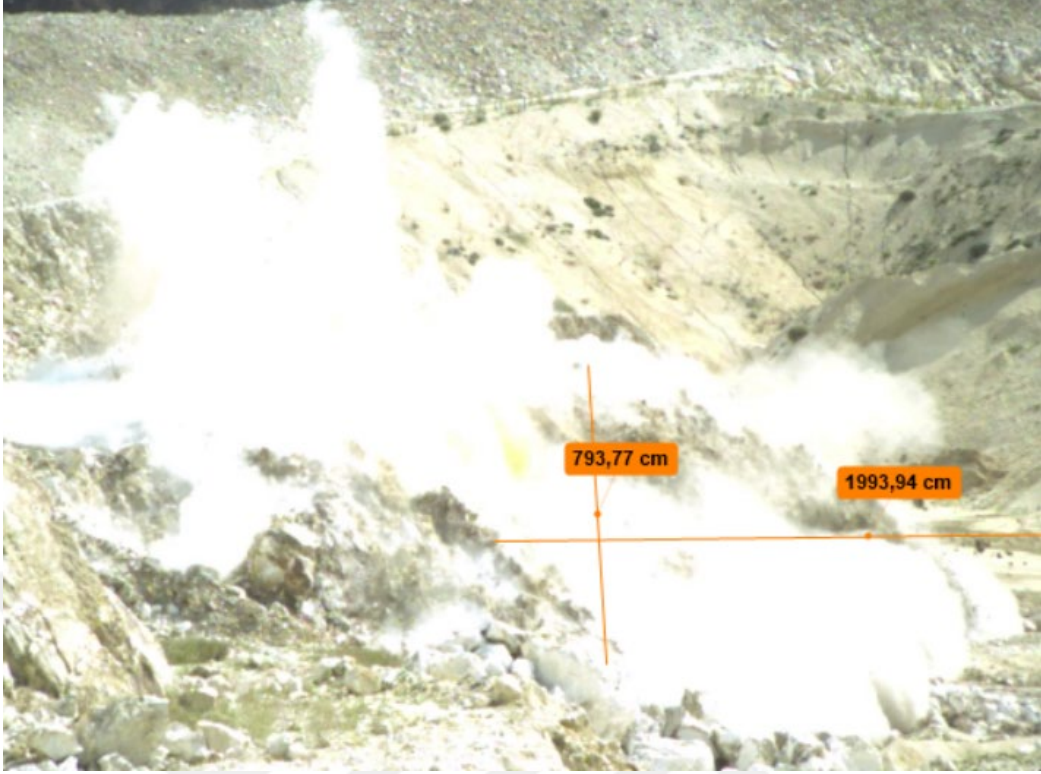
Şekil 3.3: Örnek saha kayaç savrulma mesafesi analizi
