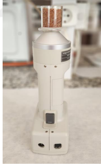
Fotoğraf 3.4. Farklı kavurma yöntemleri ile hazırlanan HÇ tozunun renk tayin cihazında ölçümleri
