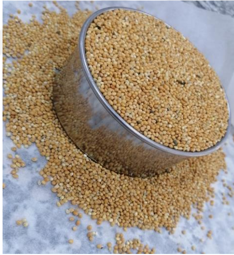
Fotoğraf 3.9. Kuşyemi kullanılarak yer değiştirme metodu ile kek örneklerinin hacimlerinin ölçülmesi
