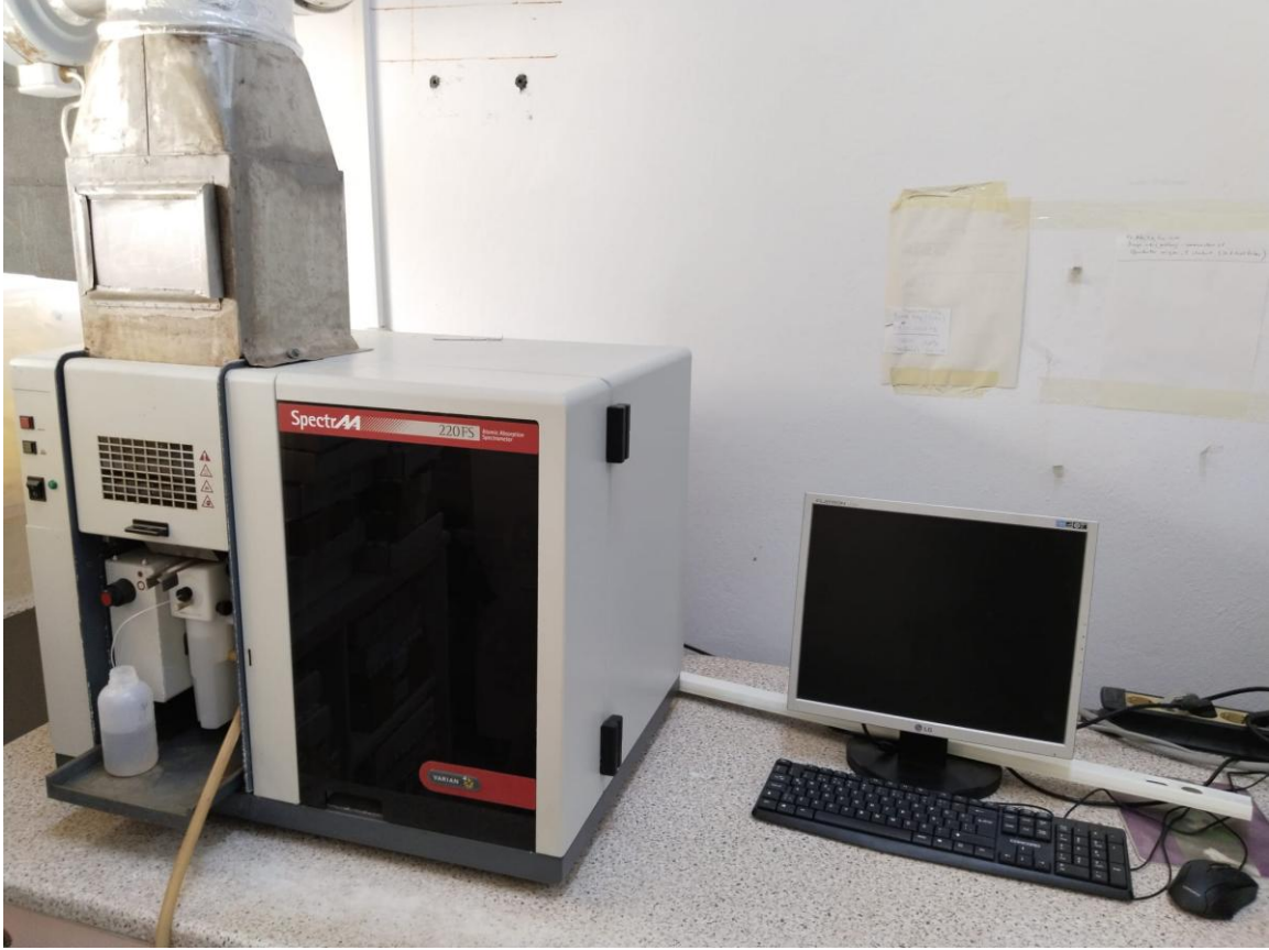
Şekil 3.15. Mineral element analizlerinin yapıldığı atomik absorpsiyon spektroskopisi cihazı
