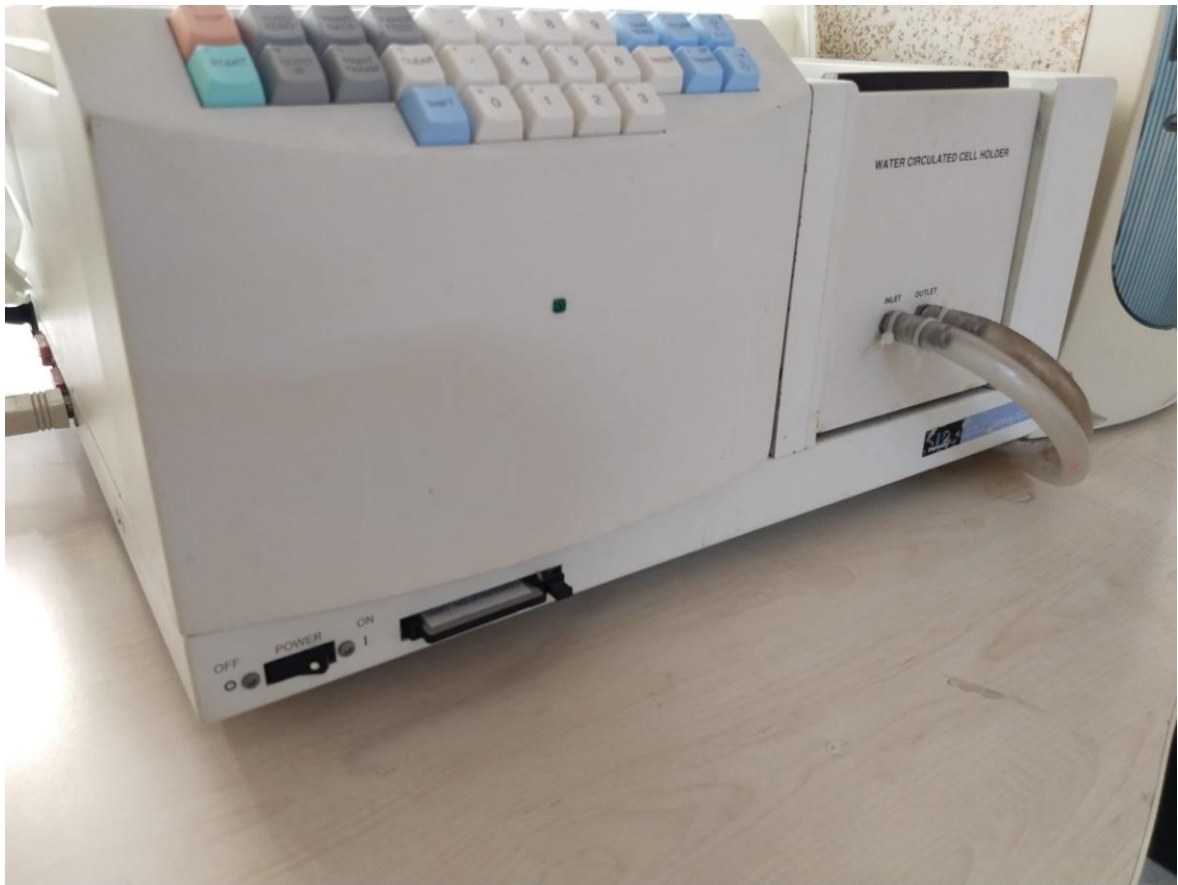
Şekil 3.13. Fosfor, Nitrat, Fenol, Flavonoid, Vitamin C ve enzim analizlerinin yapıldığı spektrofotometre cihazı
