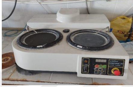
Resim 3.7 İnce ve parlak kesit hazırlama cihazı.
