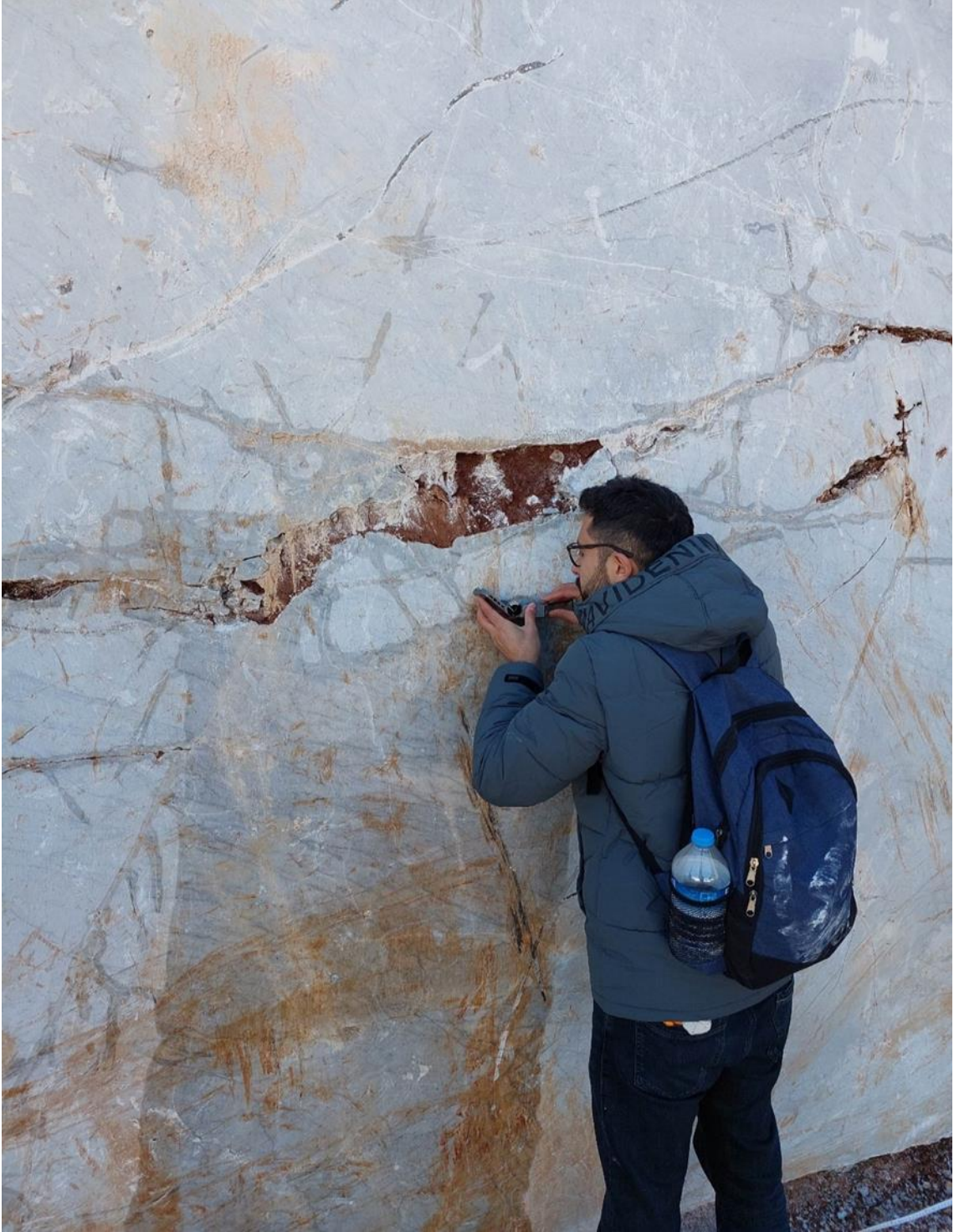
Resim 4.6 Arazi çalışmaları kapsamında ocak aynasında yapılan hat etütü alımı çalışması.
