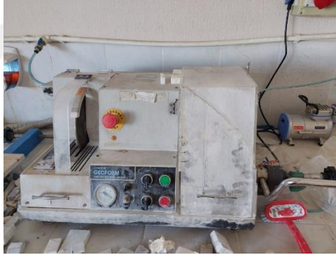
Resim 3.7 İnce ve parlak kesit hazırlama cihazı.
