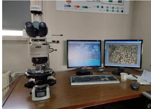
Resim 3.9 İnce kesitlerin incelendiđi polarizan mikroskop ve grntlerin alındıđı grnt analiz cihazı.
