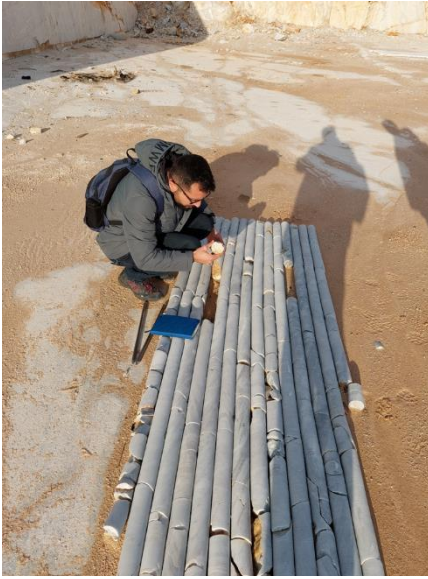
Resim 4.2 Arazi çalışmaları kapsamında ocak alanında yapılan sondaj karotlarından numune alma ve karot incelemesi.
