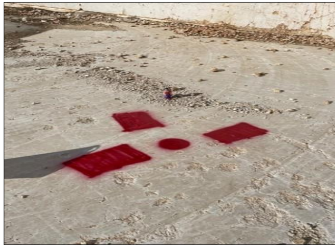
Resim 3.4 Uçuş yapılan alanda zemine işaretlenen yer kontrol noktası.
