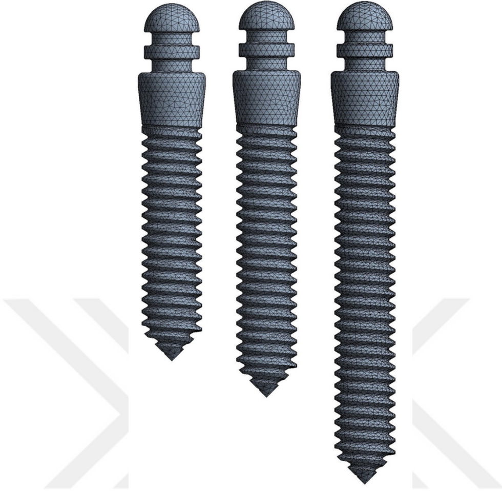
Şekil 27. İmplant modellerinin ağ yapısı
