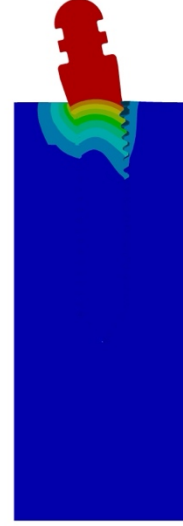
Şekil 60. Tip 1 kemik yoğunluğuna uygulanan 11,5mm uzunluğundaki mini dental implantların 100N kuvvet etkisi altındaki şekil değiştirme dağılımları A, 0,5mm kemik kalınlığı, B, 1mm kemik kalınlığı, C, 2mm kemik kalınlığı, D, 3mm kemik kalınlığı
