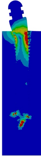
Şekil 33. Tip 1 kemik 15 mm implant modellerinin 50N kuvvet etkisi altındaki gerilme dağılımları A, 0,5mm kemik kalınlığı, B, 1mm kemik kalınlığı, C, 2mm kemik kalınlığı, D, 3mm kemik kalınlığı
