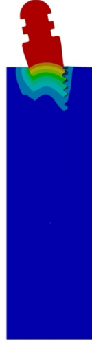
Şekil 60. Tip 1 kemik yoğunluğuna uygulanan 11,5mm uzunluğundaki mini dental implantların 100N kuvvet etkisi altındaki şekil değiştirme dağılımları A, 0,5mm kemik kalınlığı, B, 1mm kemik kalınlığı, C, 2mm kemik kalınlığı, D, 3mm kemik kalınlığı
