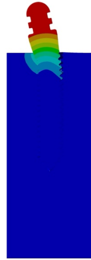
Şekil 57. Tip 1 kemik yoğunluğuna uygulanan 11,5mm uzunluğundaki mini dental implantların 50N kuvvet etkisi altındaki şekil değiştirme dağılımları A, 0,5mm kemik kalınlığı, B, 1mm kemik kalınlığı, C, 2mm kemik kalınlığı, D, 3mm kemik kalınlığı
