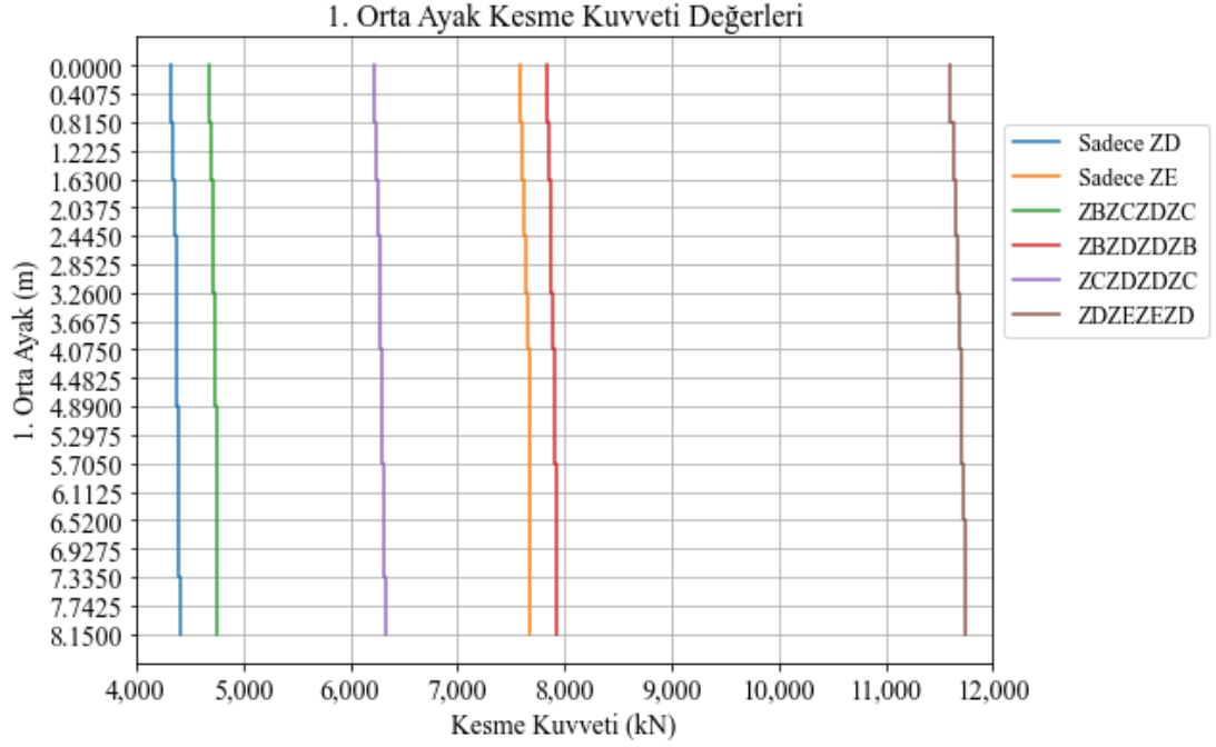
Şekil 4.27 : 1. OA ve incelenen zemin kombinasyonları için bulunan orta ayak kesme kuvvetleri (kN).
