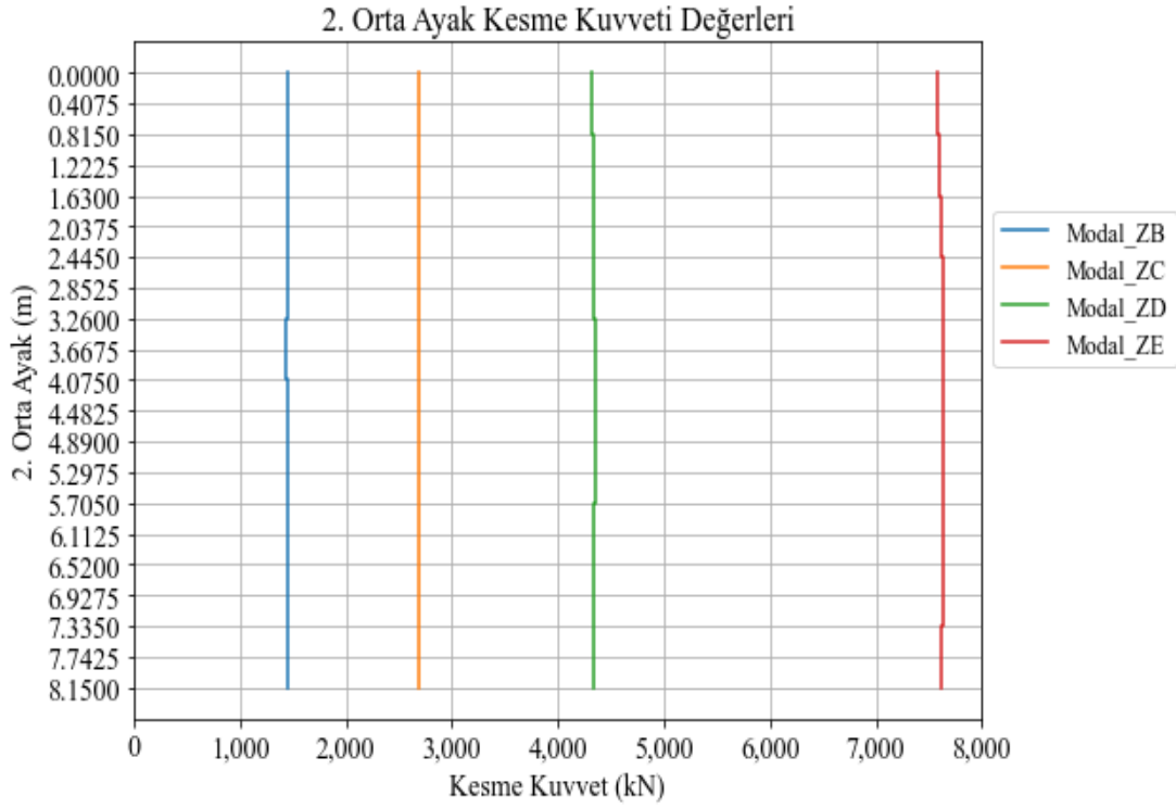
Şekil 4.17 : 2. OA'ya ait üniform deprem yer hareketi koşulları için modal ZTA ile hesaplanan kesme kuvveti değerleri (kN).
