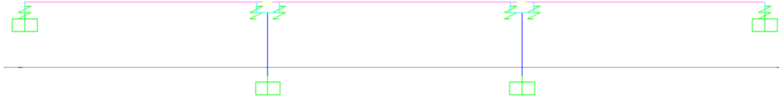
Şekil 3.18 : Kenar ve orta ayaklar için modellenen temeller.
