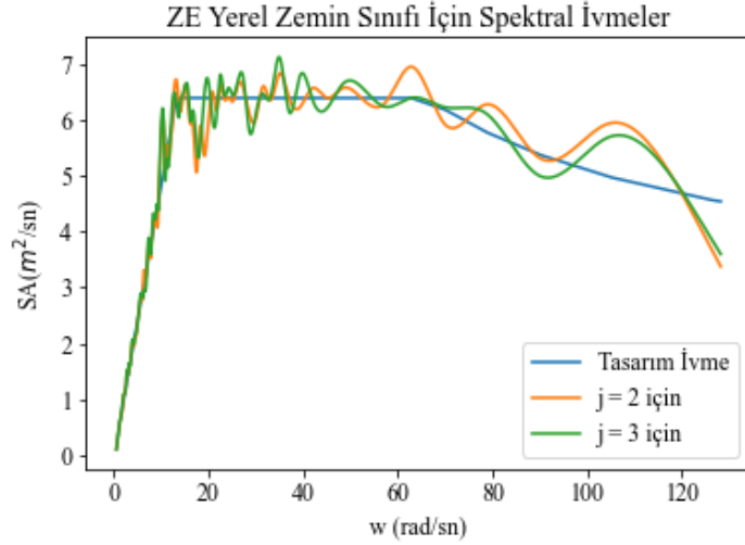
Şekil 4.12 : 10. iterasyon sonucu, j=2 ve j=3 durumları için elde edilen spektral ivmeler ve ZE tasarım spektral ivme grafiği.
