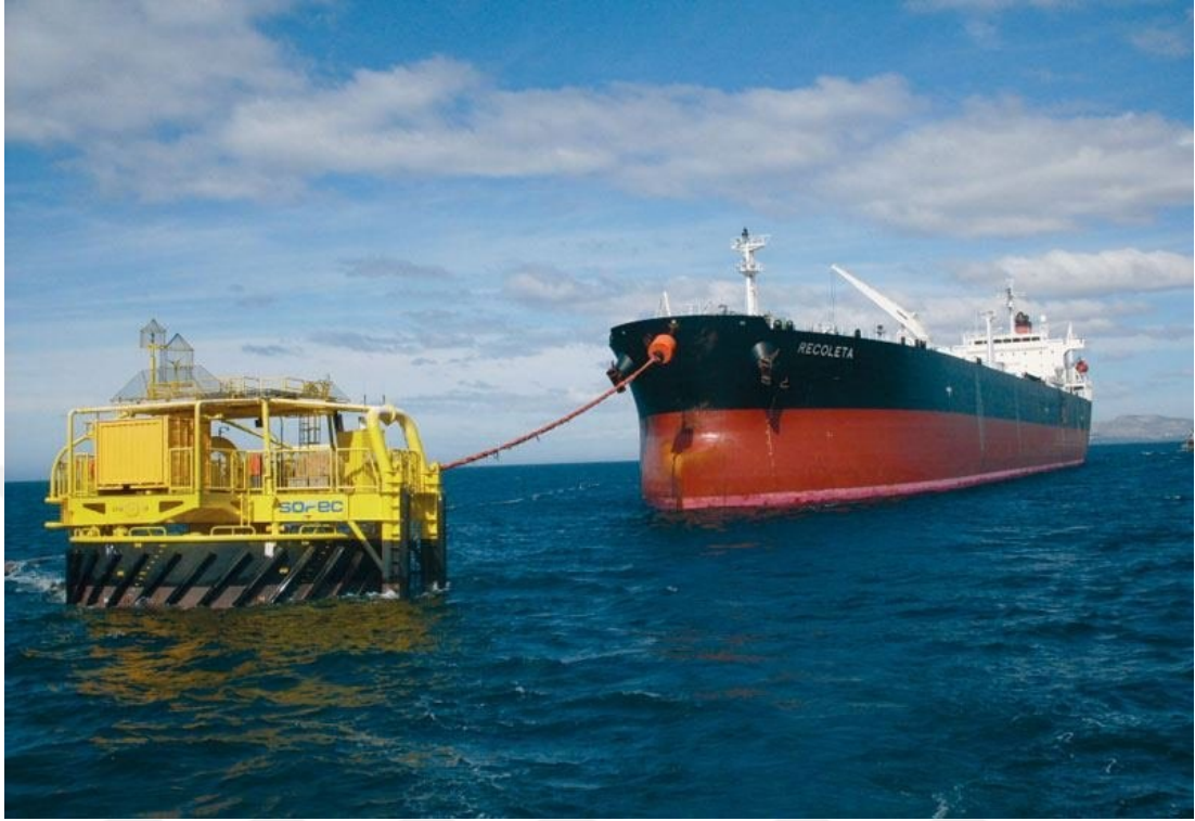
Şekil 2.22 : Açık denizde bulunan tek yönlü demirleme sistemi (Url-22).
