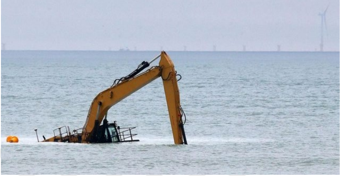
Şekil 3.19 : Gelgit ile su altında kalan bir iş makinası (Url-41).
