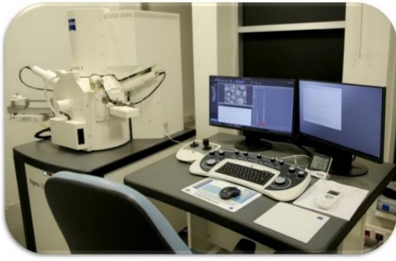
Resim 4.3. Alan emisyonlu elektron mikroskopisi (FE-SEM) (Carl zeiss-sigma 300 VP)
