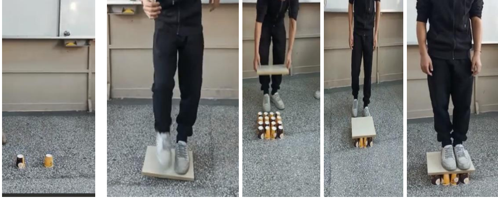
Resim 3.2. Katı basıncı yüzey alanı ilişkisi deneyi
