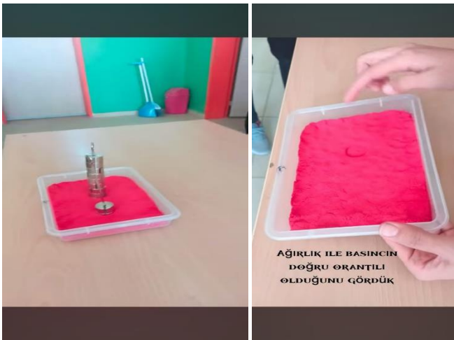
Resim 3.1. Katı basıncı ağırlık ilişkisi deneyi
