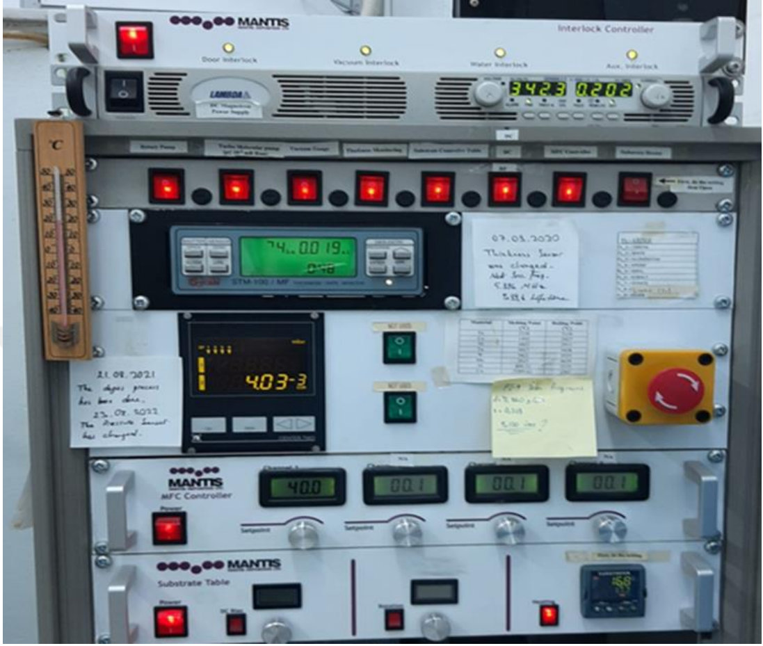
Şekil 3.1 : Film üretiminde kullanılan püskürtme sisteminin kontrol paneli.
