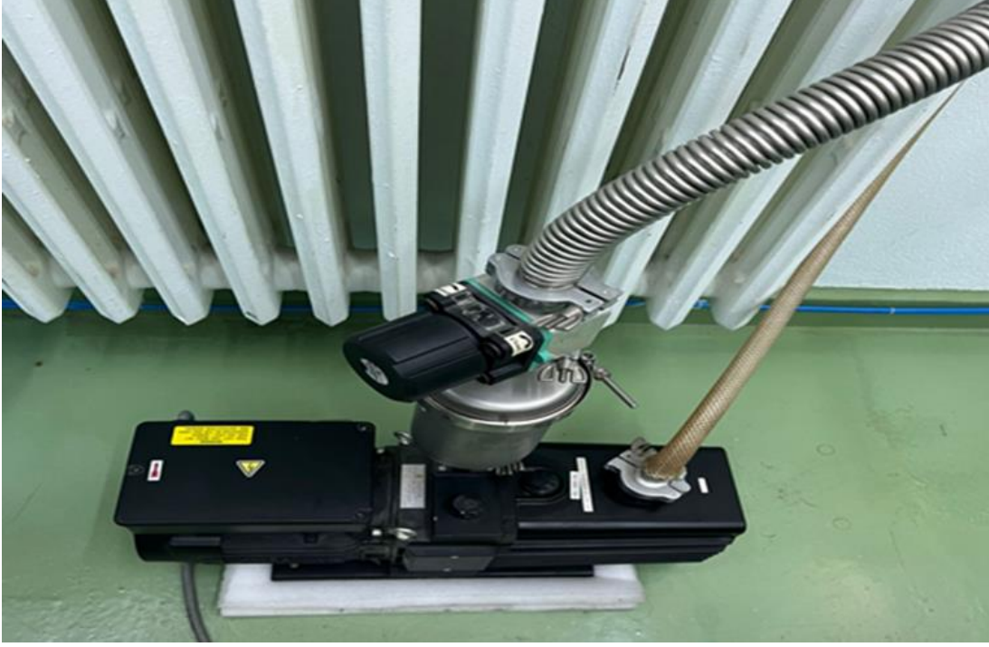
Şekil 3.2 : Vakum odasının basıncını düşürmeye yardımcı olan rotary pompa.
