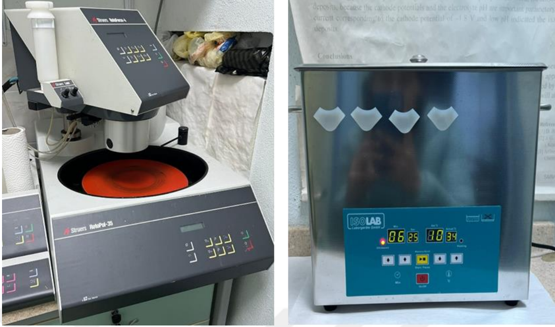
Şekil 3.7 : Zımpara makinesi RotoPol-35 (Struers) (solda) ve alt tabakanın sterilizasyonu için kullanılan ultrasonik banyo (ISOLAB) (sağda).
