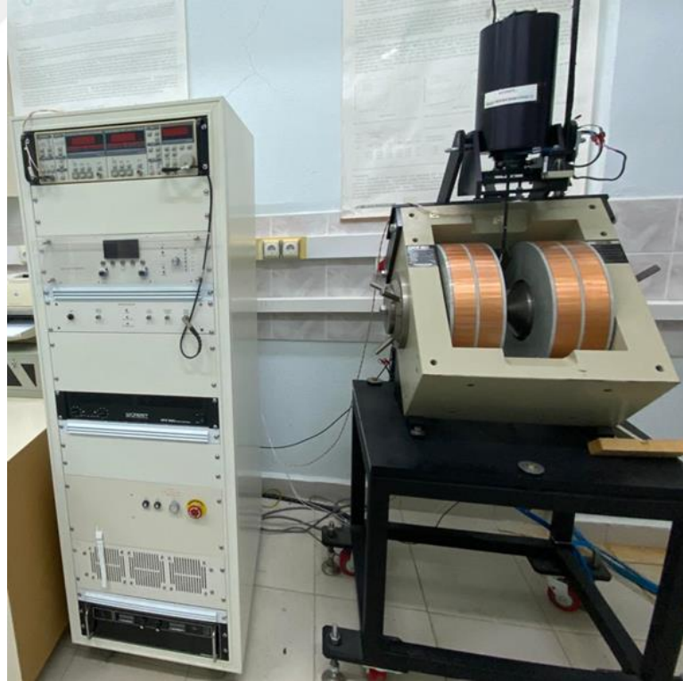
Şekil 3.13 : BAÜN Fen Edebiyat Fakültesinde bulunan VSM cihazı (ADE TECHNOLOGIES, DMS-EV9).
