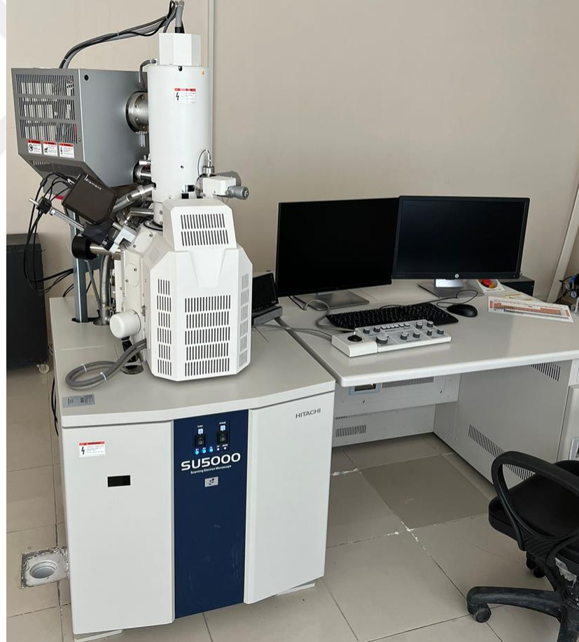
Şekil 3.11 : KMÜ BİLTEM'de bulunan SEM cihazı (HITACHI SU5000).
