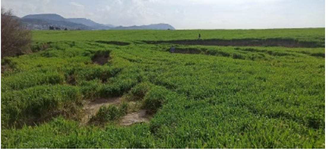
Şekil 3.12: Asi Nehri'nde gelişen yanal yayılma ve sıvılaşma Hatay stadyumu doğusu (Antakya, Hatay) (Üstün vd., 2023)
