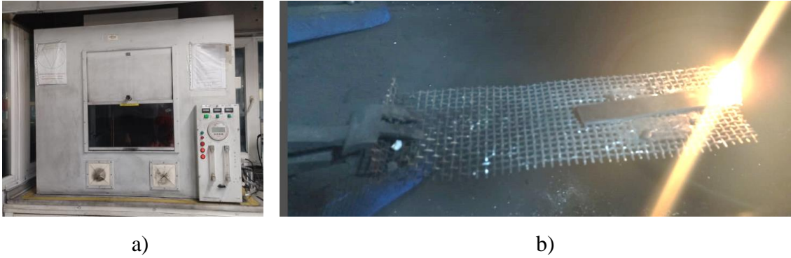
Şekil 3.18. a) FTT-01 Yanmazlık Test Cihazı, b) Yanma Testi Anı
