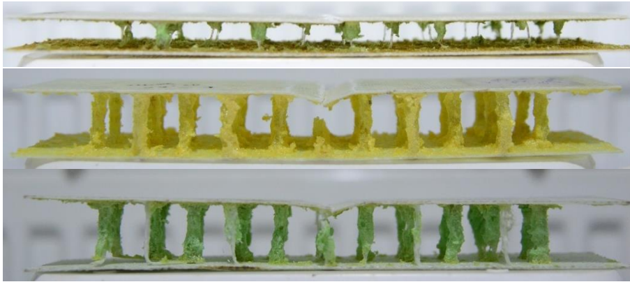
Şekil 4.24. Çekirdek malzeme içerisindeki cam elyaf iplik takviyelerinin yüzey tabakalara tutunması
