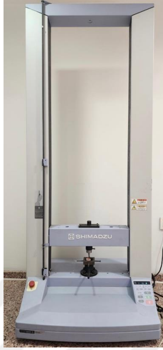
Resim 3. 5. Universal test cihazı ile yapılan kırma düzeneđi
