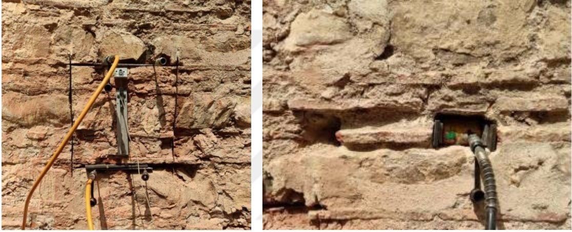
Şekil 3.13: Yerinde kayma ve Flat-jack deneylerinden görüntüler
