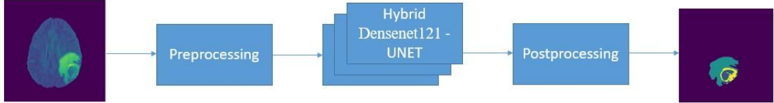
Şekil 5.4. Hibrit DenseNet121-UNet mimarisinin bir diyagramı gösterilmektedir.
