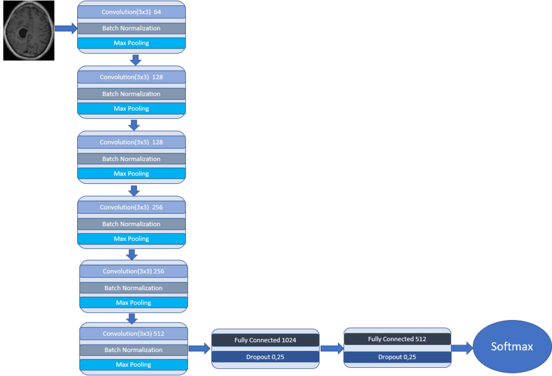
Şekil 5.9. Önerilen CNN modelinin mimarisi gösterilmiştir.
