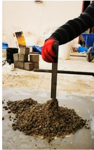
Şekil 3. 6. Slump (Çökme) deneyi
