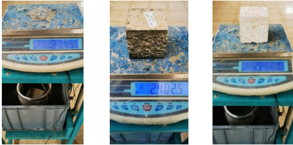
Şekil 3. 12. Numunenin Arşimet prensibine göre ağırlıklarının alınması
