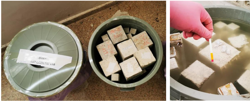
Şekil 3. 17. Asit Çözelti içerisinde numunelerin bekletilmesi
