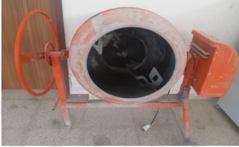
Şekil 3. 4. Karışımların hazırlanmasında kullanılan betoniyer
