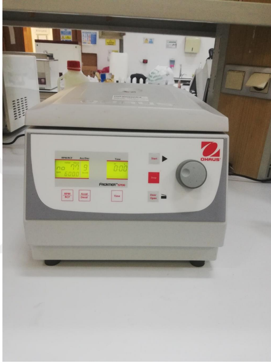
Ek-4 AT-AgNP'lerin çöktürme işleminde kullanılan santrifüj
