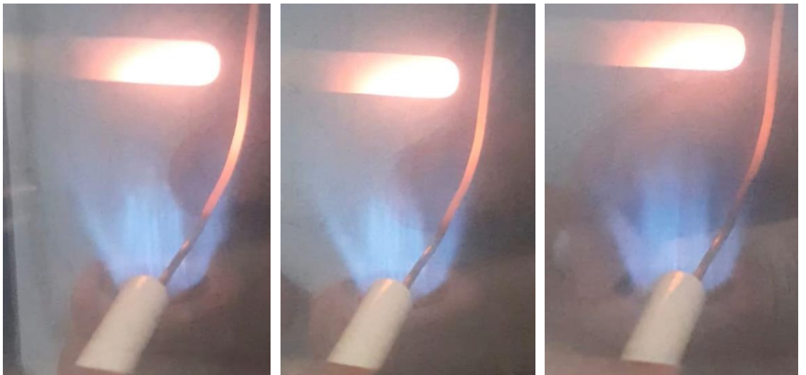
Şekil 4.13. Yakıcıya yerleştirilen manyetik alanda Saf metan yanmasının alev görüntüleri
