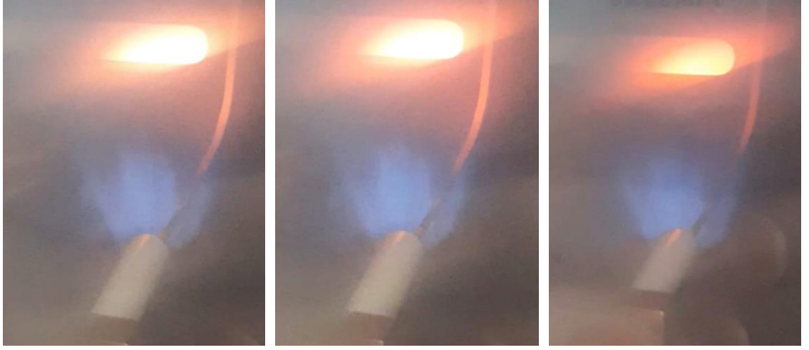
Şekil 4.11. CH 4 çıkışına yerleştirilen manyetik alanda Saf metan yanmasının alev görüntüleri
