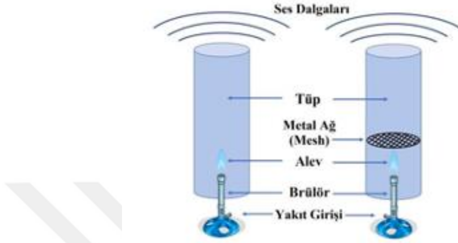
Şekil 2.1. Higgins (sol) ve Rijke’nin (sağ) deney düzenekleri
