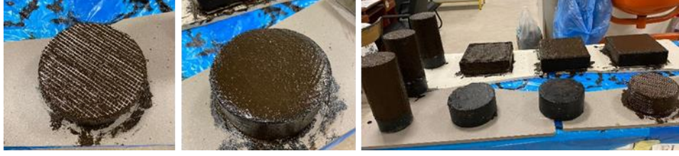
Şekil 3.11. Bitüm esaslı su yalıtımı malzemesi uygulaması
