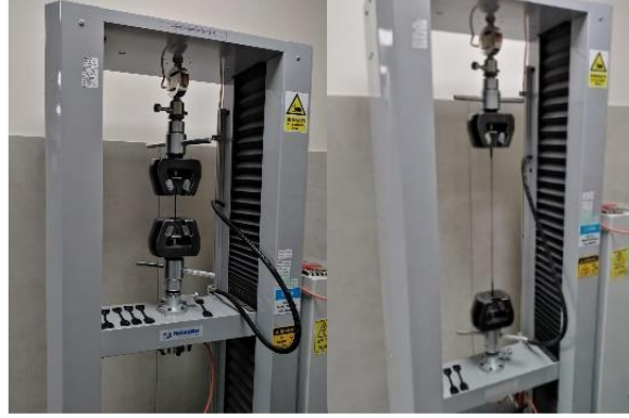
Şekil 3.18. Maksimum gerilme (çekme dayanımı) ve kopmada uzama deneyi
