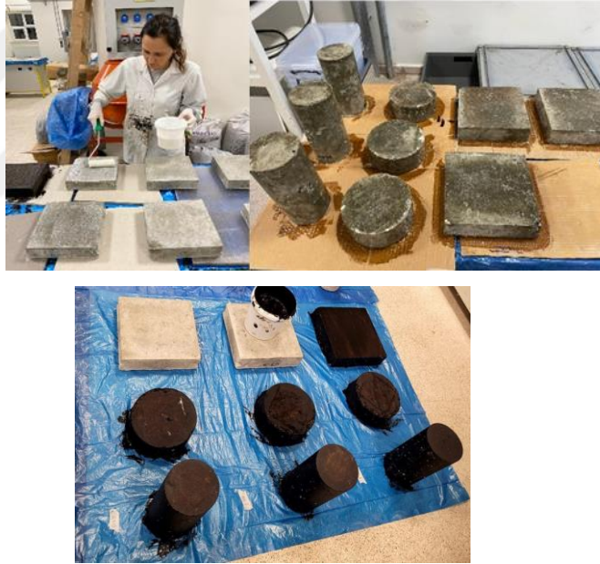
Şekil 3.10. a) Epoksi reçine esaslı astar, b) Bitüm emülsiyon esaslı astar
