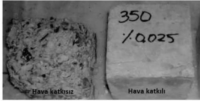
Şekil 2.6. 140 kez donma-çözülme çevrimine maruz kalan beton numune [3]
