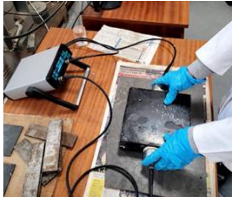
Şekil 3.20. Yalıtımlı numunelere uygulanan ultrases dalga hızı deneyi
