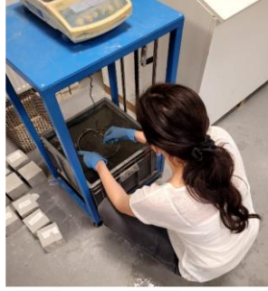
Şekil 3.6. İri agregaya tane yoğunluğu deneyi (Arşimet düzeneği)
