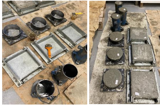
Şekil 3.9. Beton numune üretimi
