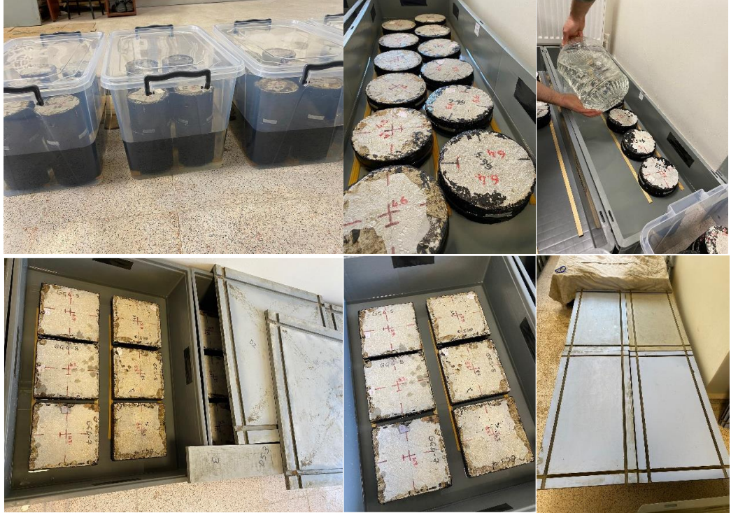
Şekil 3.16. Su yalıtımlı beton numunelerin çözeltilere yerleştirilmesi
