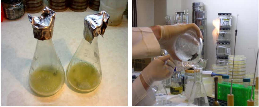
Şekil 9.1: Laura Bertani (LB) Besiyeri ve Escherichia coli Bakteri Kültürü Ortamına Konulan Magnezyum Alaşım Numuneleri
