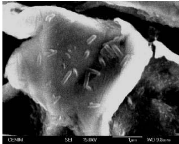
Şekil 8.3: Korozyona Uğramış Çelik Parçasına Tutunan Mikroorganizmalar SEM Görüntüsü [78].
