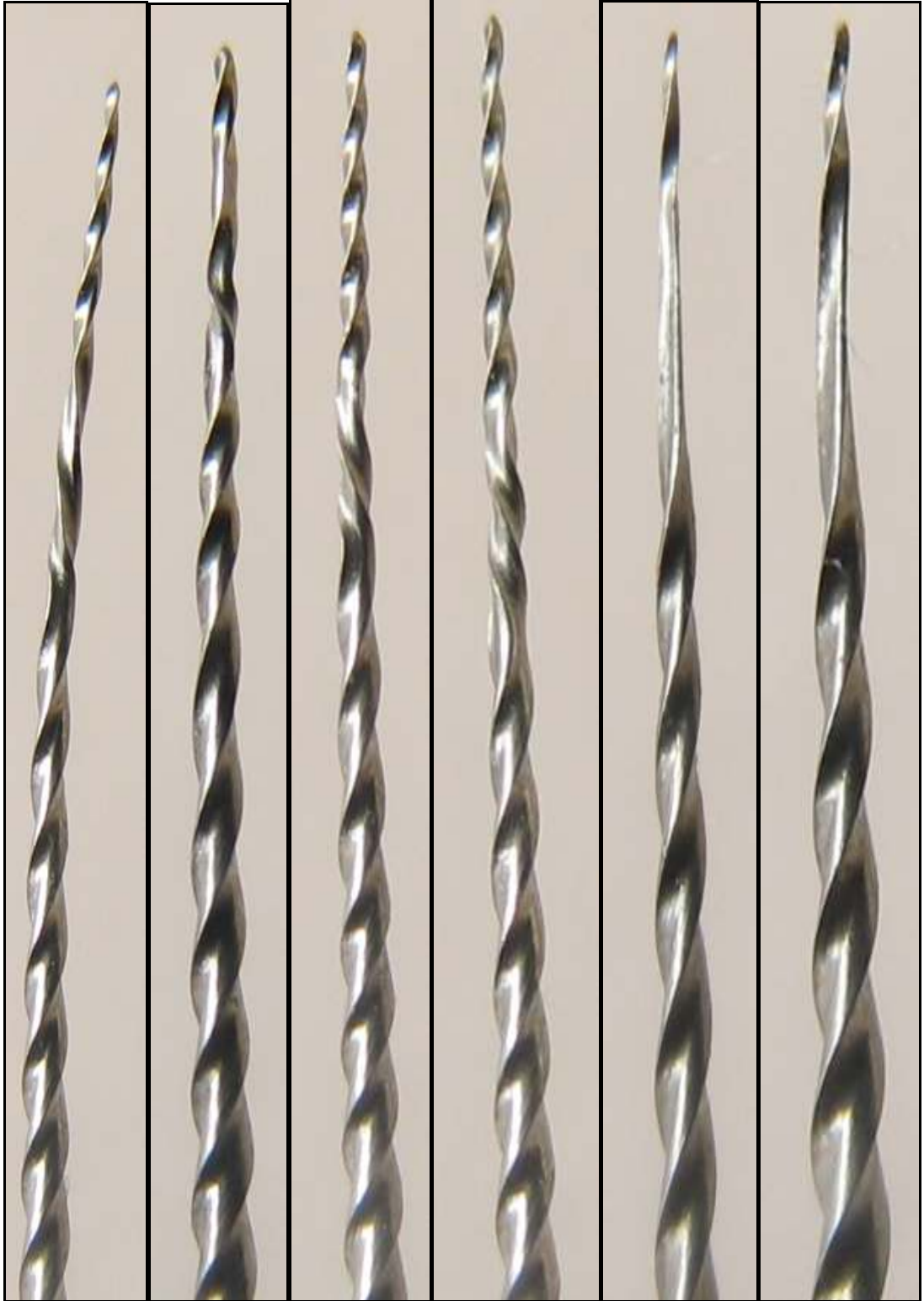
Şekil 4.2. HEROShaper .04/25 ve .04/30 numaralı kanal aletlerinde oluşan deformasyonlar.
