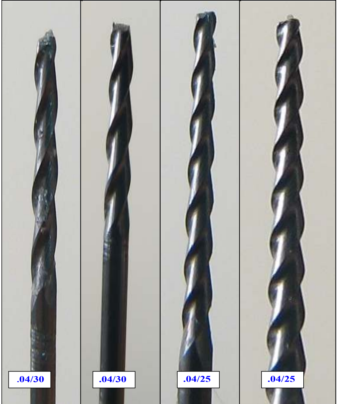
Şekil 4.5. Döngüsel yorgunluk testinde kırılan HEROShaper Ni-Ti kanal eğesi örnekleri.
