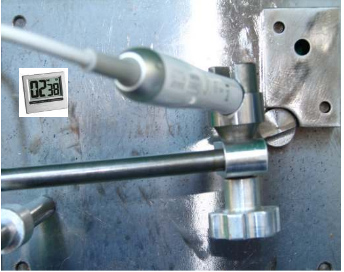
Şekil 3.12. ProTaper ve HEROShaper döner sistem Ni-Ti enstrumanların döngüsel metal yorgunluğu sonucu kırılma sürelerinin kronometre ile hesaplanması
