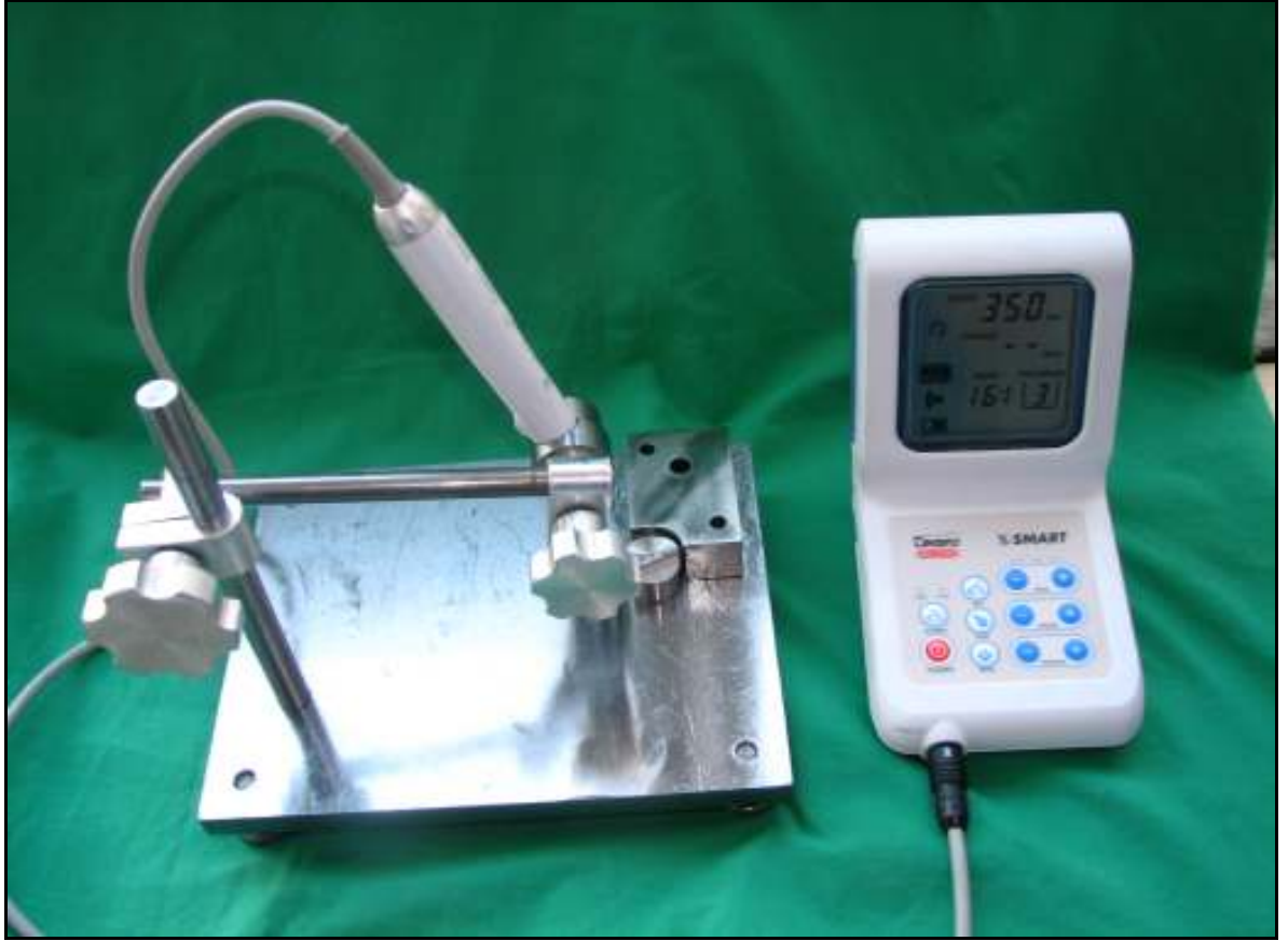
Şekil 3.10. Gambarini modeline uygun olarak tasarlanan döngüsel metal yorgunluğu test cihazı ve tork kontrollü endodontik motor düzeneği.
