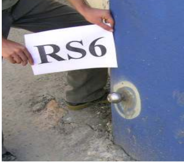
Şekil 4.4: Bölgede Tesis Edilen Düşey Kontrol Noktaları
