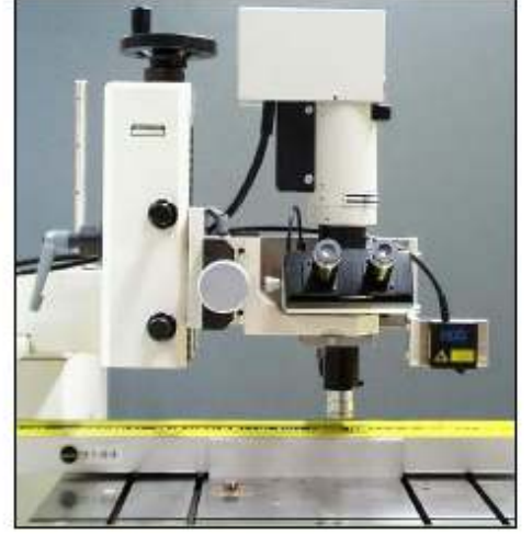
Şekil 3.4: Yatay Komparatör ve Elektro-optik Mikroskop
