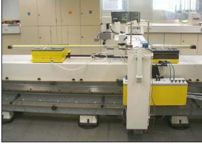
Şekil 3.4: Yatay Komparatör ve Elektro-optik Mikroskop
