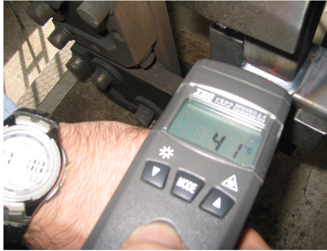
Şekil 5.19: Fikstür Üzerinde Soğuma Hızlarının Ölçümü
