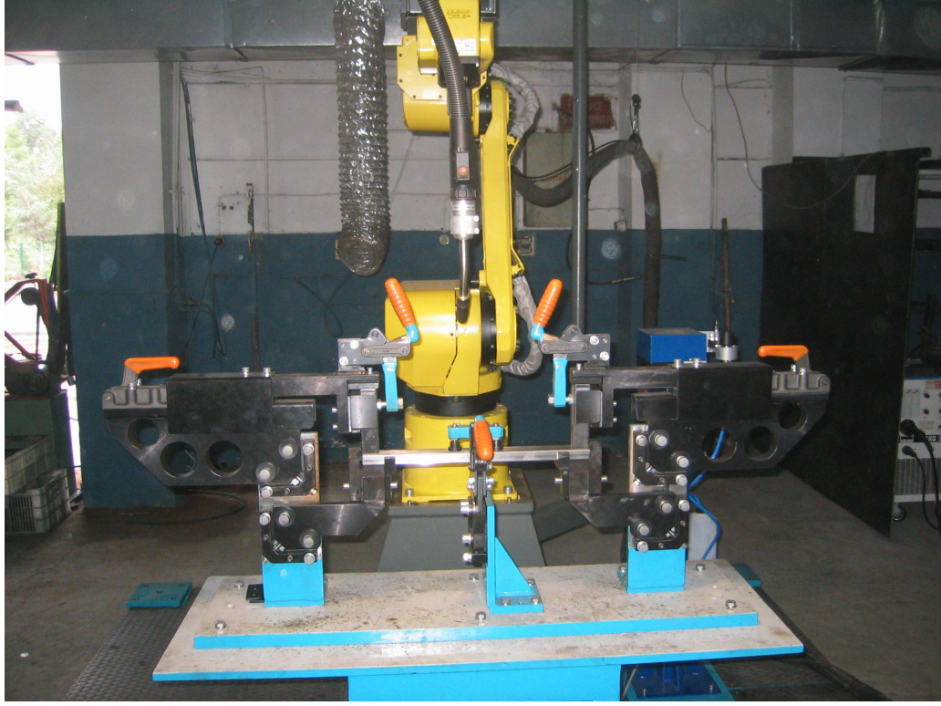
Şekil 5.17: Robotlu Kaynak Sistemi
