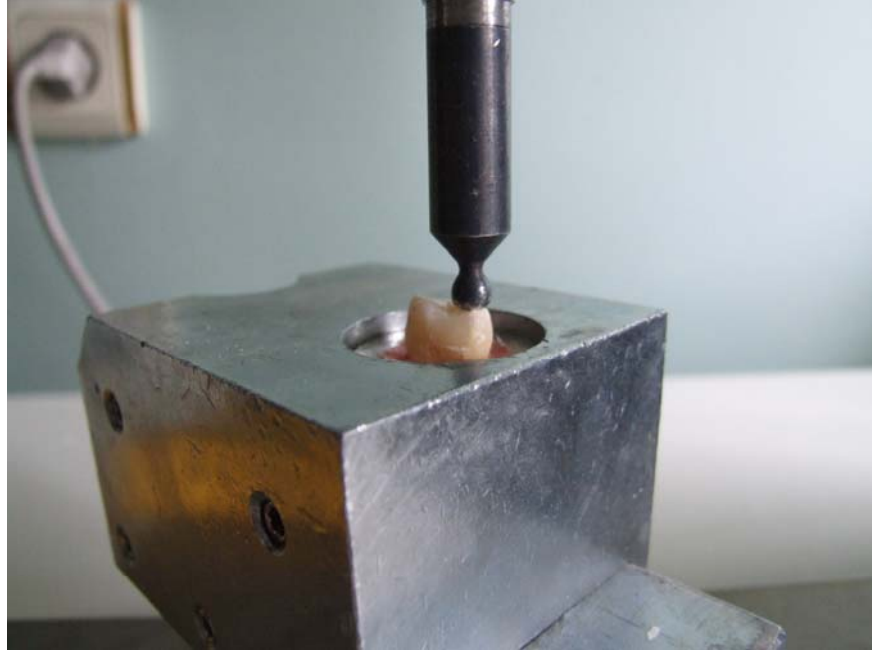
Resim 11: Kırma cihazında modelin yerleşimi.
