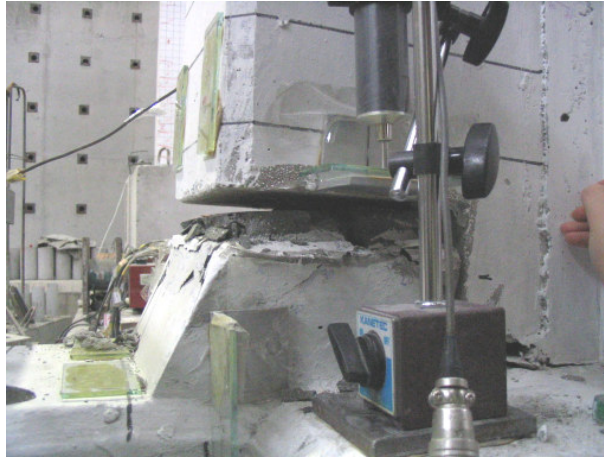
Şekil A. 5 Karma numune #1 döşeme kısmı basınç halinde iken kolon gusesi ile giriş açılması
