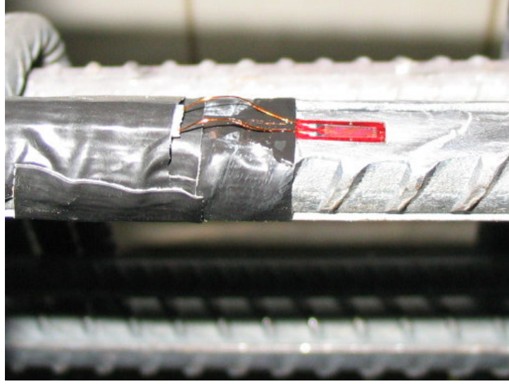
Şekil 3-3 : Standart gerilme ölçer donatı üzerine monte edilmiş.
