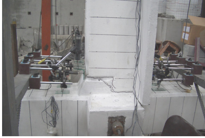
Şekil A. 10 Karma numune #2 plastik deformasyonların başlaması yan görünüşü.
