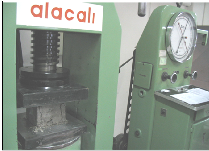
Şekil 3-11 : Beton küp numunesi basınç testi
