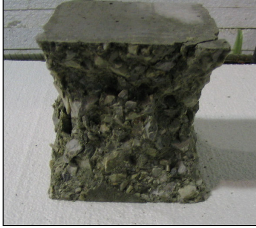
Şekil 3-27 : Kayma eksenli doğrultularında kırılmış beton test numunesi
