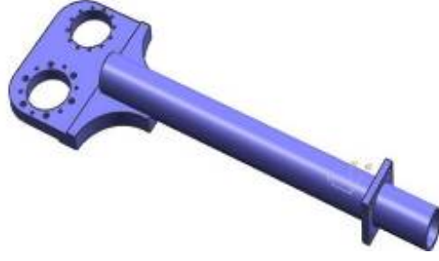
Şekil 3.7 : Taşıyıcı kol katı modeli [13]
