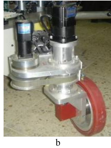
Şekil 3.8 : Tahrik sistemi; a) katı modeli, b) uygulaması [13]
