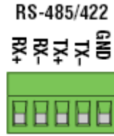
Şekil 4.25 : RS-485 bağlantı klemensi [22]
