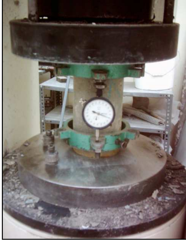
Şekil H.1: Silindir basınç deney düzeneği
