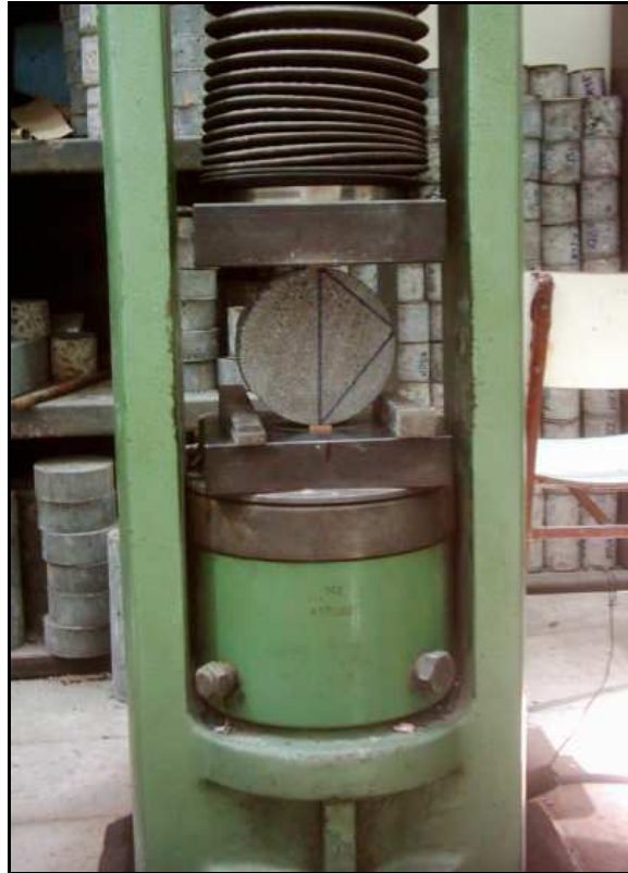
Şekil H.2: Yarmada çekme deney düzeneği
