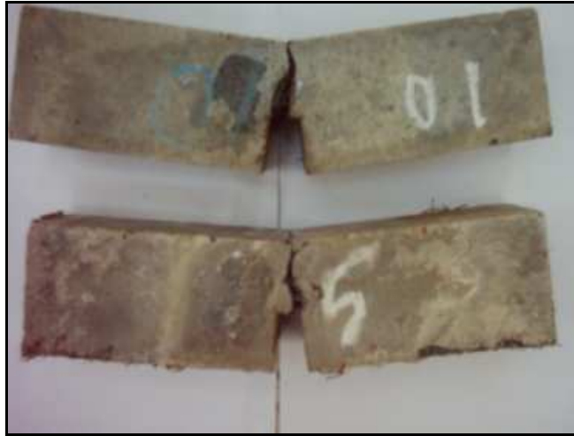
Şekil H.9: RILEM kırılma enerjisi deneyi uygulanmış OZC ve OZN numuneleri
