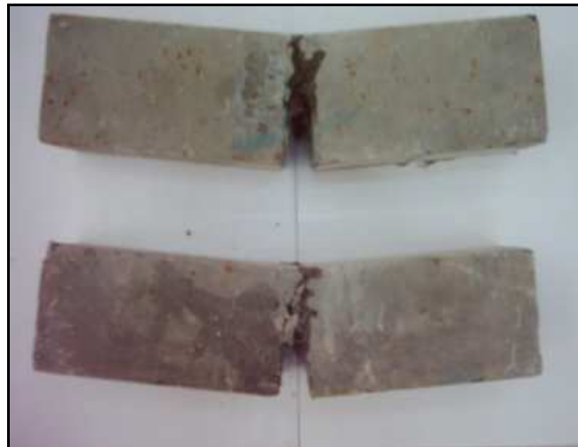
Şekil H.7: RILEM kırılma enerjisi deneyi uygulanmış ZC ve ZN numuneleri
