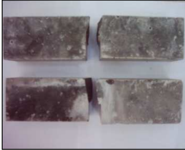
Şekil H.5: RILEM kırılma enerjisi deneyi uygulanmış MC ve MN numuneleri
