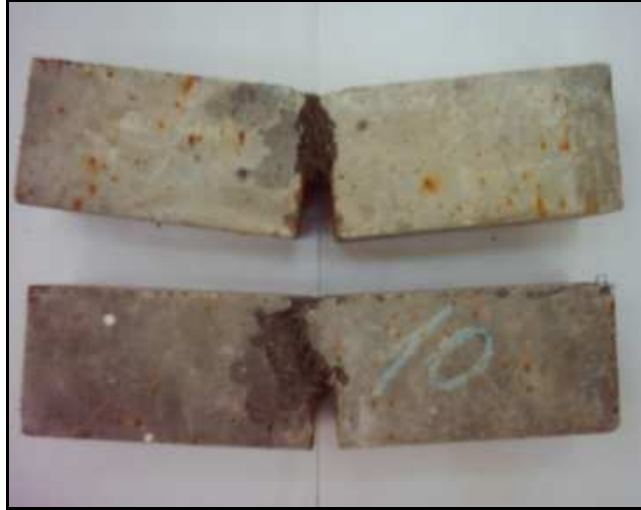
Şekil H.8: RILEM kırılma enerjisi deneyi uygulanmış XC ve XN numuneleri
