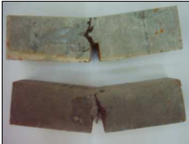
Şekil H.10: RILEM kırılma enerjisi deneyi uygulanmış OXC ve OXN numuneleri
