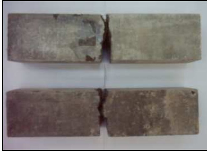
Şekil H.6: RILEM kırılma enerjisi deneyi uygulanmış OC ve ON numuneleri
