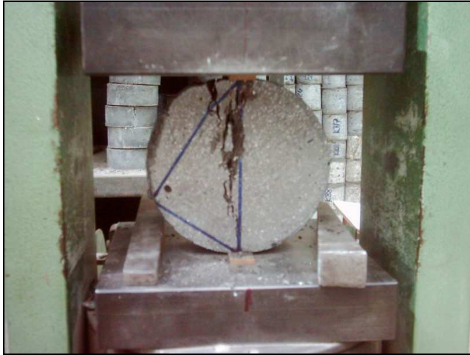
Şekil H.4: Yarmada çekme deneyi uygulanmış lifli numune
