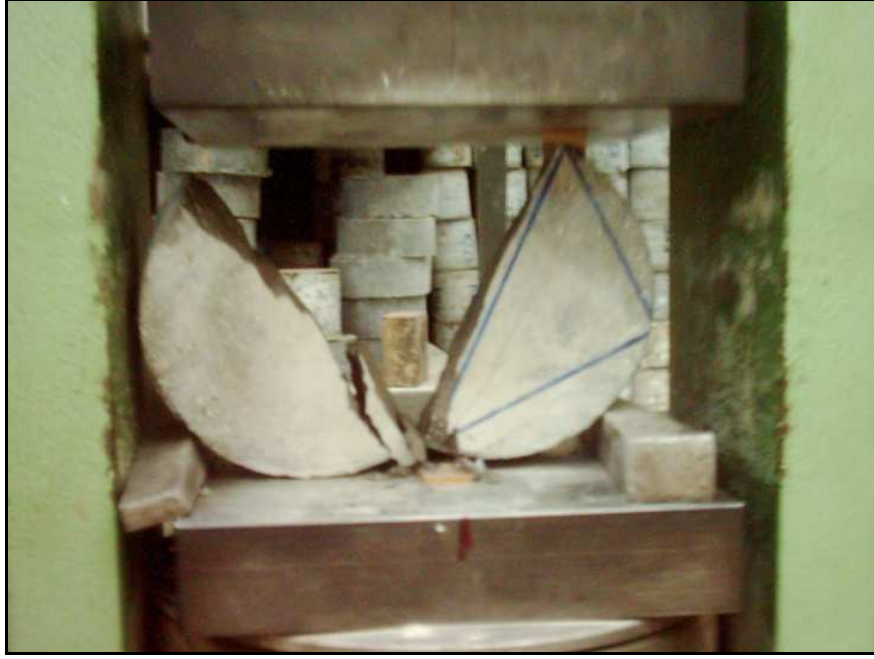
Şekil H.3: Normal kür uygulanan lifsiz numune
